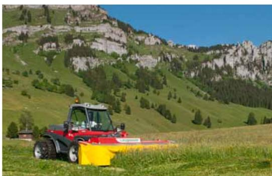
Les régions montagneuses engendrent des contraintes élevées pour la technique. PÖTTINGER a adapté depuis 2003 le développement de sa gamme de faucheuses frontales à disques NOVAALPIN à ces conditions d'utilisation. Des machines robustes, légères et ne nécessitant que peu de puissance en sont le résultat.
