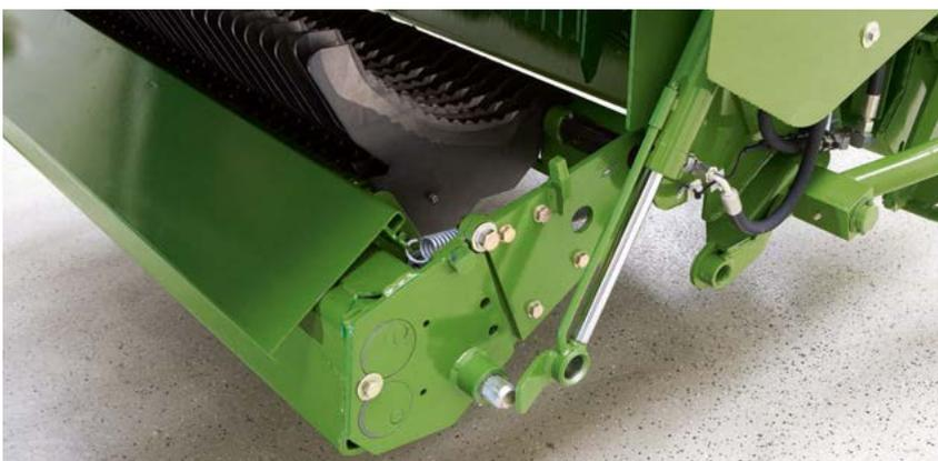
Le verrouillage est ensuite automatique lors du pivotement de la barre de coupe vers l'intérieur.
