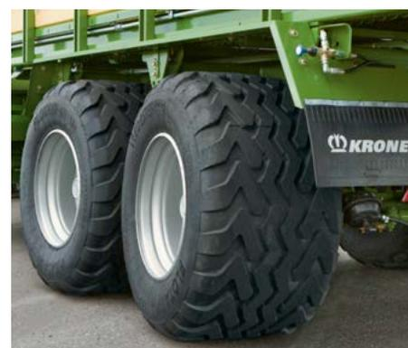
**Essieu tandem portique non directionnel, sans suspension et une charge admise par essieu de 10.000 kg
