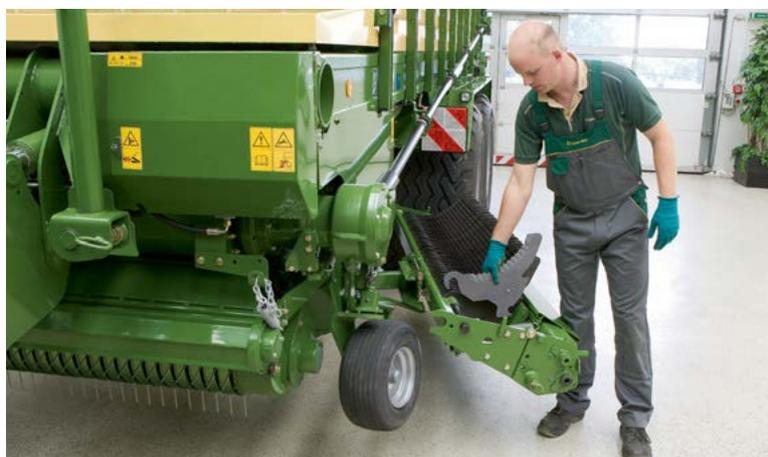
Lors du pivotement de la barre de coupe vers l'intérieur, le verrouillage est automatique.
