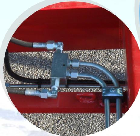
Clapet anti-retour pour verrouillage de porte, ensemble de la tuyauterie en rigide bichromatée
