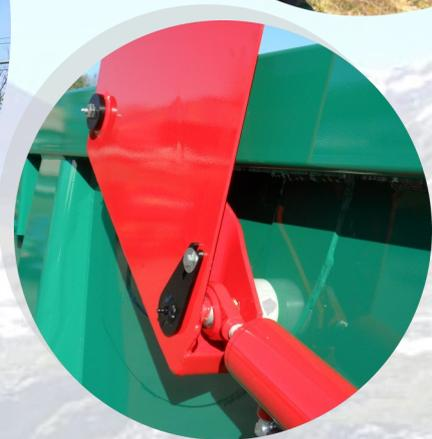
Guidage permanent avec galets téflon, des bras de porte
