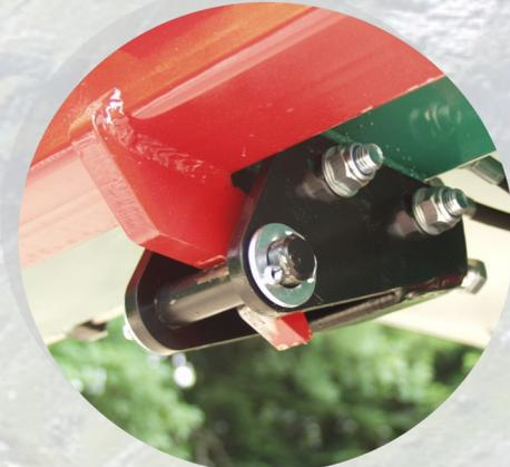
Crochet de verrouillage sur porte et axe réglable sur caisse
