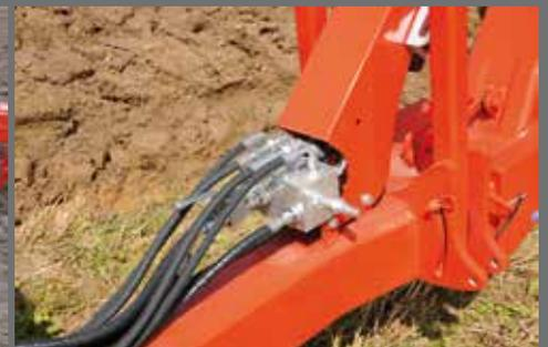
4. Pour plus de sérénité, la robustesse de la structure est garantie par un bâti mécano-soudé largement dimensionné = 180 x 180 mm.
