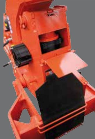
2. Profondeur : par des cales positionnées sur le vérin de relevage. Tous les efforts sont axiaux = aucune contrainte dans les axes. Le repérage est aisé par comptage des cales
