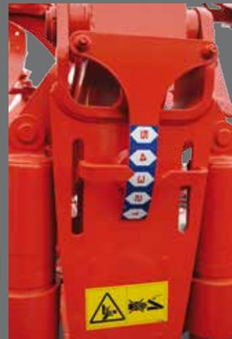
3. Déport : par tirant mécanique ou vérin hydraulique (en option) permet un ajustement à des entre pneu de 1,15 à 1,60 m. Un indicateur visible depuis le poste de conduite facilite le repérage pour un réglage précis
