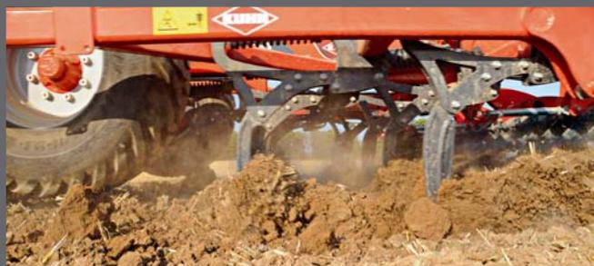
La profondeur de travail de la dent est maintenue constante grâce à la nouvelle sécurité non stop mécanique à double ressort. Dans tous les types de terre et surtout en présence de pierres, la pression à la pointe de 600 à 800 kg permet un travail homogène.
