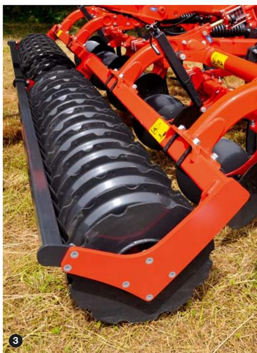
Réglage simple de la profondeur de la machine par cales **1** et sur les bras **2** de relevage.
