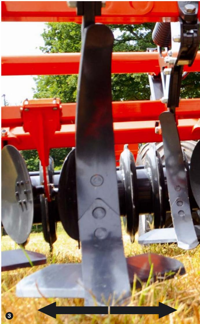
③ Le travail est efficace même en présence de pierres. L'acier à haute limite élastique permet un dégagement latéral de la dent. Elle va chercher à se déplacer sur les côtés avant de s'escamoter à la verticale.
