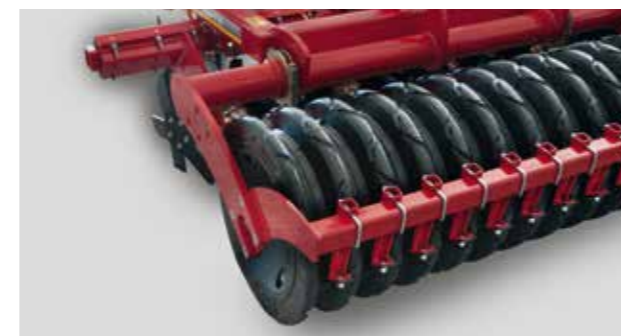
Le rouleau FarmFlex est équipé de décroisseurs efficaces et robustes garantissant une évolution sans bourrage
