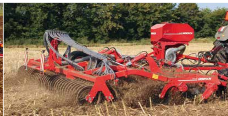
Joker RT avec DuoDrill en option pour une productivité maximale en semis de colza et de couverts. Idéal sur sols légers à moyennement lourds pour profiter de l'humidité du sol. Le DuoDrill comprend une trémie de 460 litres.
