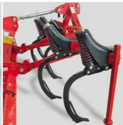
Mono TG : Efficace pour fissurer en profondeur. Dents TerraGrip avec socs étroits (faible perturbation). Les socs fissurent le sol en profondeur sans remonter de mottes en surface.
