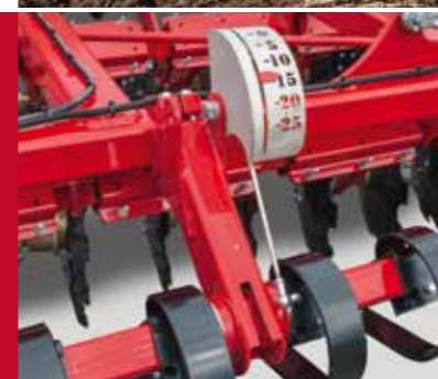
Crossbar Réglage hydraulique de la profondeur pour un résultat parfait du travail
