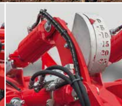
Option Réglage hydraulique de profondeur pour Joker 5/6/8 RT
