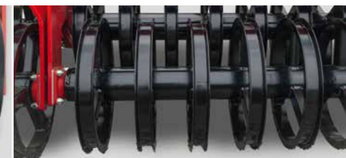
Rouleau RollPack double pour un bon émiettement et ré-appui du sol
