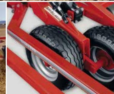
En lieu et place de la triple herse, il est possible de monter une rangée de disques de nivellement suivie d'une rangée de herse.
