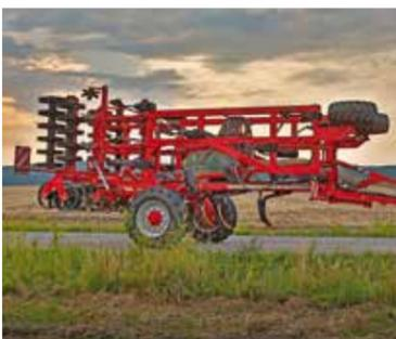
Essieu central pour des manœuvres réduites en fourrière et une maniabilité supérieure sur route
