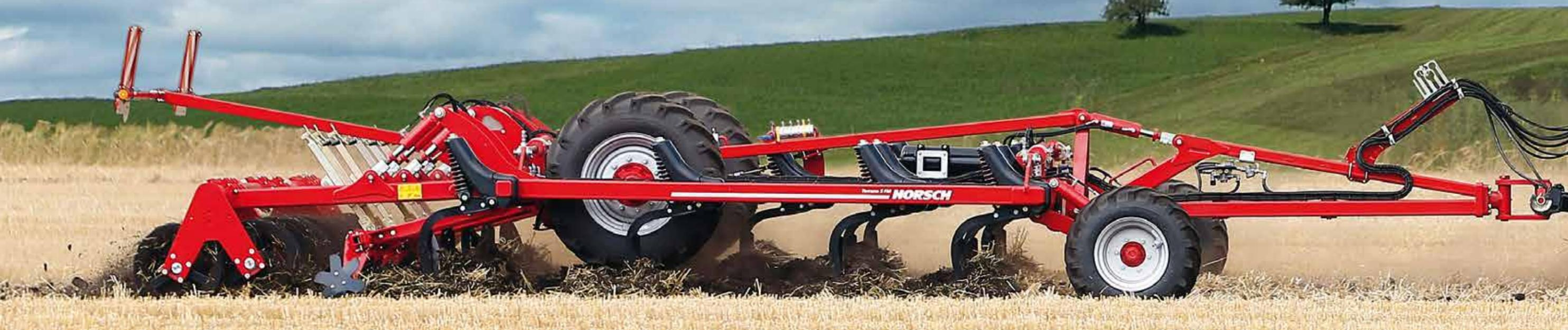
Le **Terrano FM** est adapté au travail superficiel comme profond. Il permet un mélange intensif grâce à sa conception en 4 rangées de dents tout en étant faible demandeur de puissance, ceci grâce à un interrang de 28 cm.
