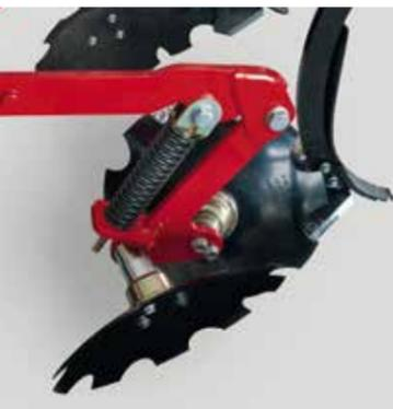
Disques de nivellement à sécurité ressort
