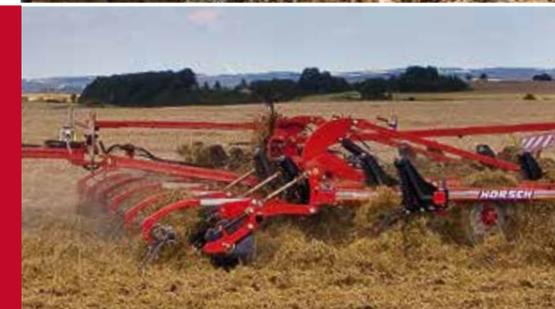
En lieu et place de la triple herse, il est possible de monter une rangée de disques de nivellement suivie d'une rangée de herse.
