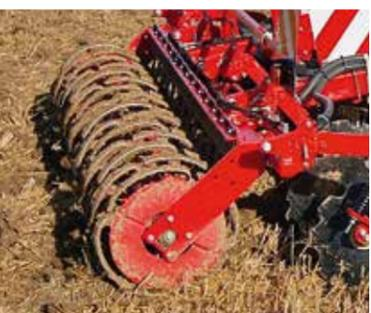
Rouleau RollFlex pour un ré-appui en profondeur avec un émiettement de la surface
