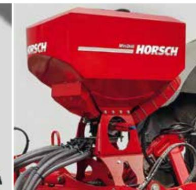
MiniDrill avec sa trémie de 400 l
