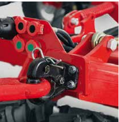
Crochet d'attelage arrière avec prises hydrauliques et électriques
