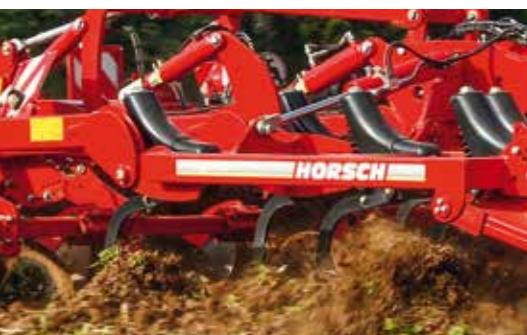
Dent TerraGrip Escamotage jusqu'à 30 cm, déclenchement à 500 kg, aucun entretien
