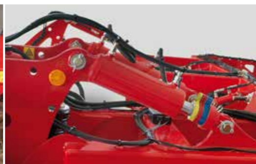
Réglage variable de la profondeur de travail par cales d'épaisseur
