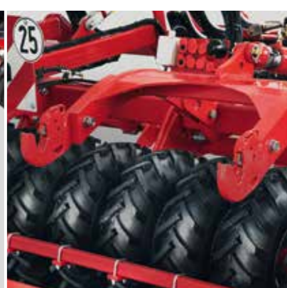
Bras de relevage arrière avec prises hydrauliques et électriques
