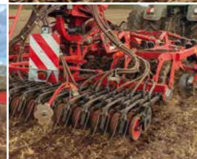
Rampe de semis TurboDisc Interrang de 15 cm, suspension caoutchouc, pression réglable jusqu'à 120 kg par élément semeur
