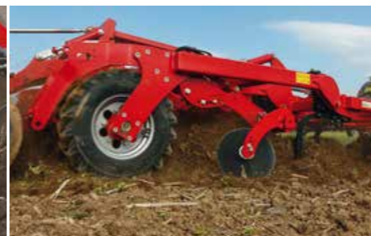
Packer à pneus Consolidation en profondeur et respectueuse du sol
