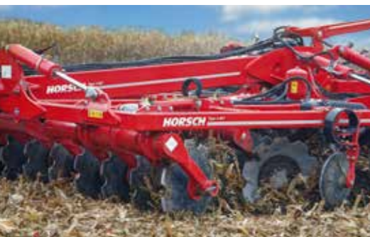
DiscSystem lourd Montage sur deux rangées, diamètre des disques 68 cm, espacement entre disques 40 cm, disques crantés avec support unique
