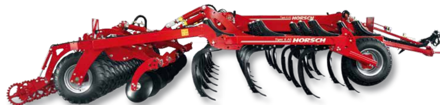
Tiger AS Conception du châssis en quatre rangées, interrang de 23 cm, dégagement sous bâti de 85 cm, 1 rangée de disques de nivellement, packer à pneus et packer TopRing
