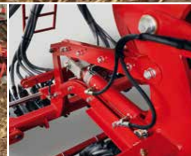
Pronto TD Réglage individuel de la profondeur de semis par cales d'épaisseur
