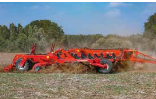
TerraGrip Mélange intensif et fissuration grâce à la conception en quatre rangées
