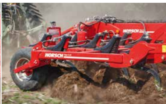
Sécurité hydraulique des dents TerraGrip pour un effort à la pointe jusqu'à 770 kg (option pour la 1ère et 2ème rangée de dents des Tiger 5, 6, 8 AS)
