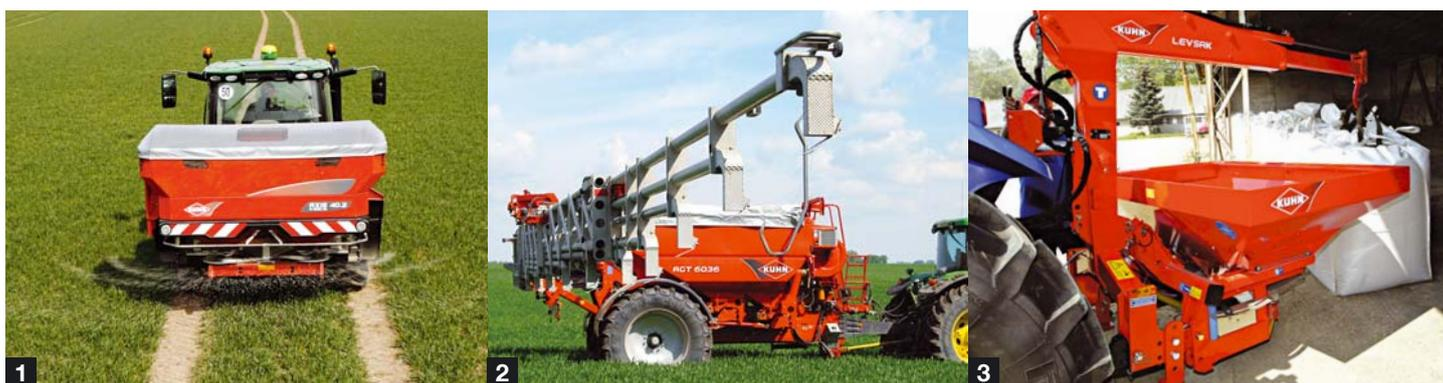
1. Distributeurs d'engrais centrifuges 2. Distributeurs d'engrais pneumatiques 3. Bras de manutention.
