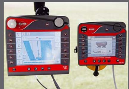
CCI avec CCI.Command (Section Control + Parallel Tracking) + VT 50 (affichage machine)
