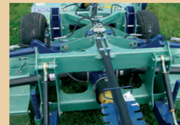
Vérin de repliage Nécessite 1 D.E. avec valve de retenue de charge
