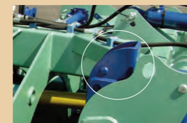
Butée amortisseur Réglage hauteur de travail et absorbe la variation de relief
