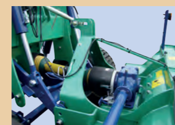
Attelage 3 pts hydraulique Relevage du broyeur arrière pour circulation sur route
