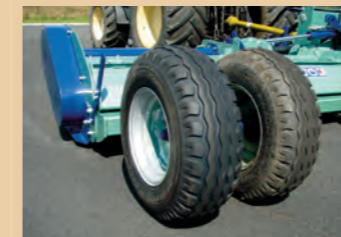
Roues semi-pivotantes jumelées Paires de roues semi-pivotantes de série : 10,0/75 x 15,3. Réglable en hauteur, écartement variable.
