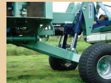
Vérins Vérins de montée/descente du châssis central
