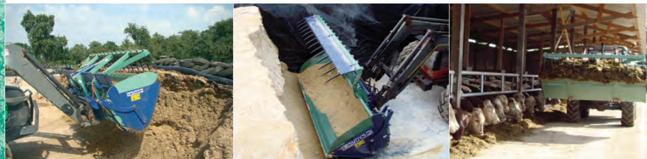
Vérin situé à l'arrière permettant l'accès à ras des murs du silo, + protection du vérin.
