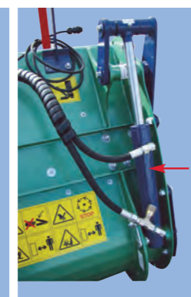
Vérin situé à l'arrière permettant l'accès à ras des murs du silo, + protection du vérin.
