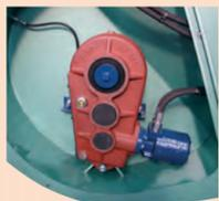
Entraînement par moteur hydraulique et boîtier réducteur
