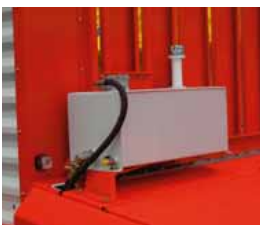
Centrale hydraulique pour le tapis de déchargement
