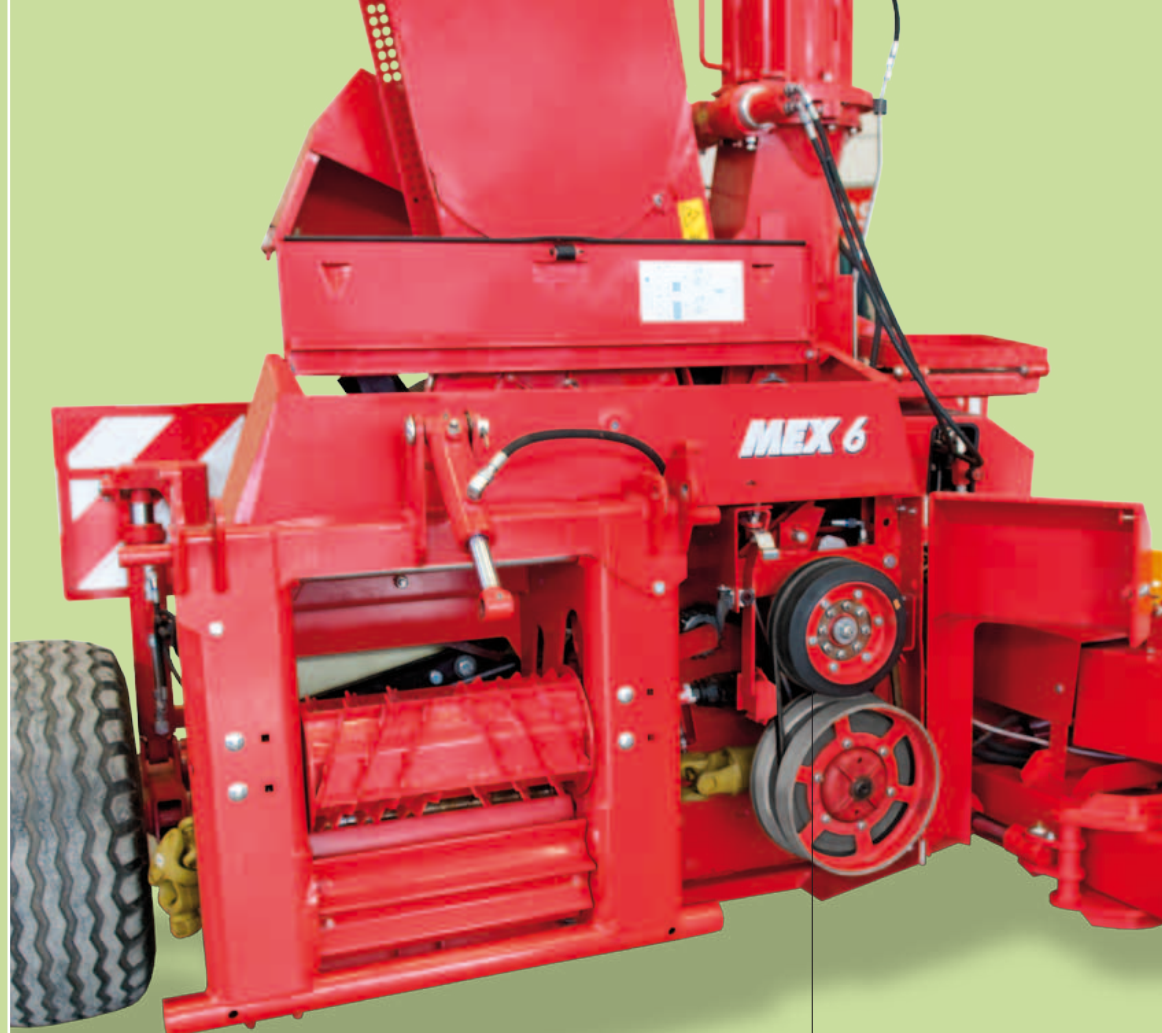
Inverseur d'entraînement avec modification facile de la longueur de coupe - 5 / 7 / 9 mm
