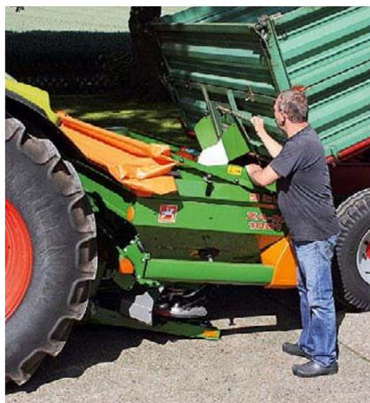
Remplissage avec une benne basculante
