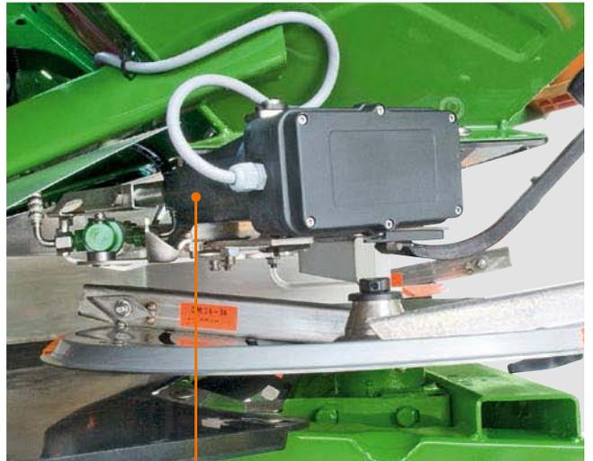
Servomoteur électrique robuste pour les trappes de dosage
