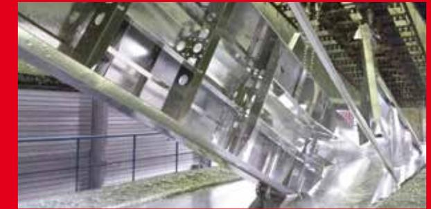
L'ensemble de la gamme **Muck Master** est galvanisé suivant un principe d'immersion dans un bain de zinc à 450°C. L'intérieur et l'extérieur de l'épandeur se retrouvent ainsi recouverts et protégés. Ce procédé assure une longévité maximale ainsi qu'une résistance aux matières les plus corrosives.
