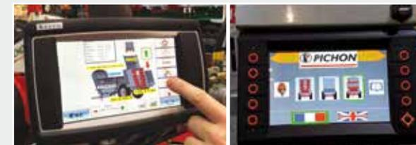
**Le DPAE (Débit Proportionnel à l'Avancement)** ajuste le débit d'épandage en faisant varier la vitesse de défilement du tapis en fonction de la largeur de travail et de la hauteur du produit contenu dans l'épandeur. Le système DPAE avec compteur d'épandeur est doté d'un capteur de vitesse situé au niveau du moyeu.
