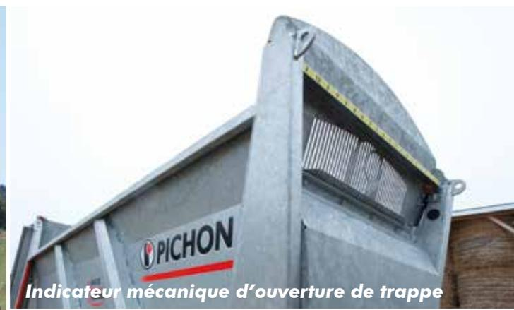
*Indicateur mécanique d'ouverture de trappe*
