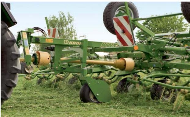
**Roue d'appui à l'avant :**
