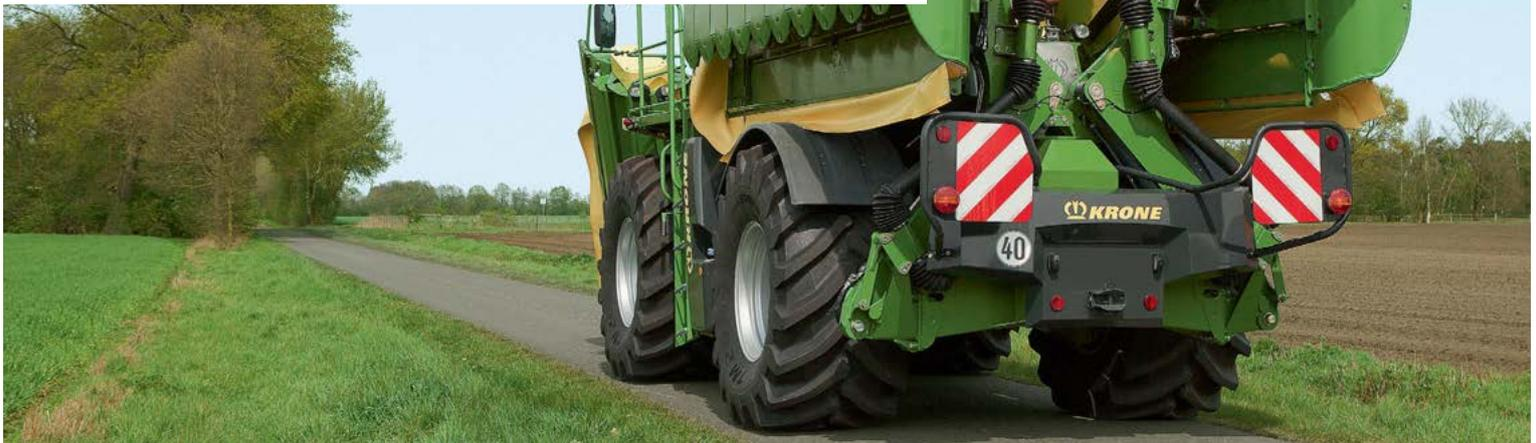
Qu'il s'agisse de braquages larges ou de manœuvres délicates, le système d'entraînement hydraulique de la KRONE BiG M 500 impressionne. Avec un entraînement toutes roues motrices permanent, vous vous déplacez en mode champ jusqu'à 20 km/h et sur route jusqu'à 40 km/h. Si nécessaire, il est possible de séparer le circuit hydraulique pour que chaque essieu soit alimenté en huile séparément par une pompe. KRONE offre ainsi une traction optimale, même sur les terrains les plus difficiles.
