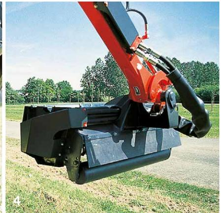
Constituée d'une carcasse aux multiples renforts (1), d'une tôle d'usure démontable, d'un rotor en épaisseur 10 mm, de chicanes anti-fil de fer (2), de patins d'usure interchangeables et d'un capot sens herbe, la tête de coupe vous offre le plaisir de travail d'une gamme professionnelle.
