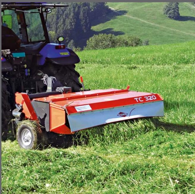
En terrains accidentés, le conditionneur arrière KUHN TC 320 complète parfaitement les faucheuses frontales GMD 1020 F COMPACT. La machine est très stable, même dans les pentes raides, grâce à son attelage fixe avec des axes inférieurs oscillants et des roues positionnées près de l'axe du rotor conditionneur.
