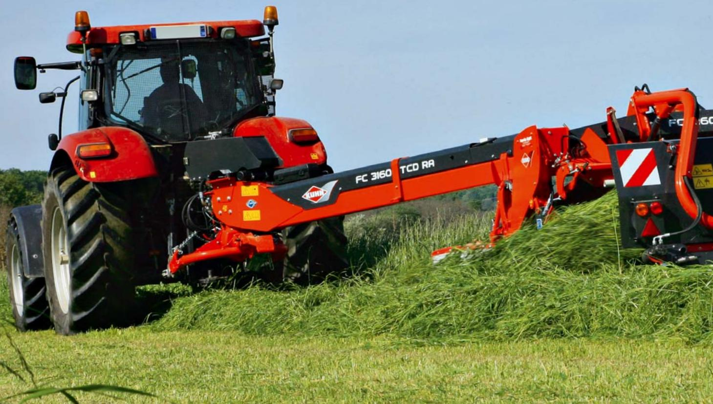
Les modèles FC 3160/3560 TCD RA sont conçus pour un usage professionnel par des entrepreneurs, grandes exploitations et CUMA. Leur tapis groupeur arrière en fait des machines idéales pour la récolte de tous types d'ensilage. En même temps, elles offrent une flexibilité maximale avec différentes options de dépose.
