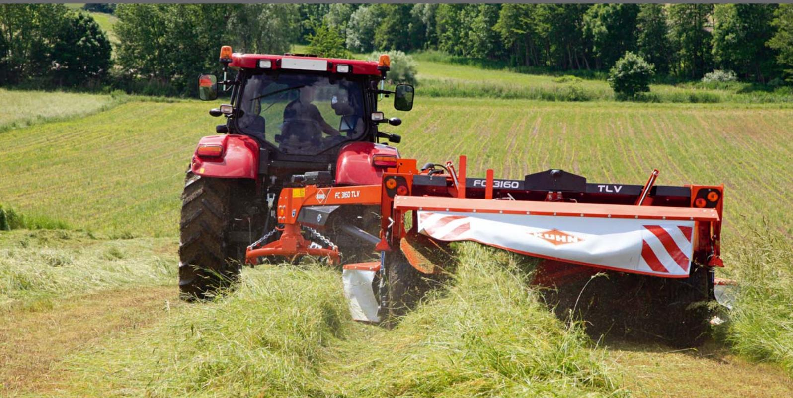
Avec 3,10 m de coupe, un conditionneur à doigts à 2 vitesses et des volets hydrauliques, la faucheuse conditionneuse FC 3160 TLV peut délivrer 2 andains jumelés. Elle regroupe 6 m de fauche sur un andain qui n'excède pas 2,80 m. Une dimension idéale pour une reprise par ensileuse avec un pick-up n'excédant pas 3 mètres.
