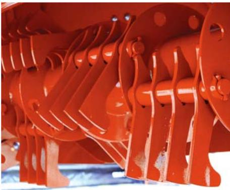
Que le fourrage soit lourd, long ou à maturité avancée, les doigts en acier sont une alternative efficace pour son conditionnement. Les doigts pivotent et peuvent si nécessaire éviter un obstacle.
