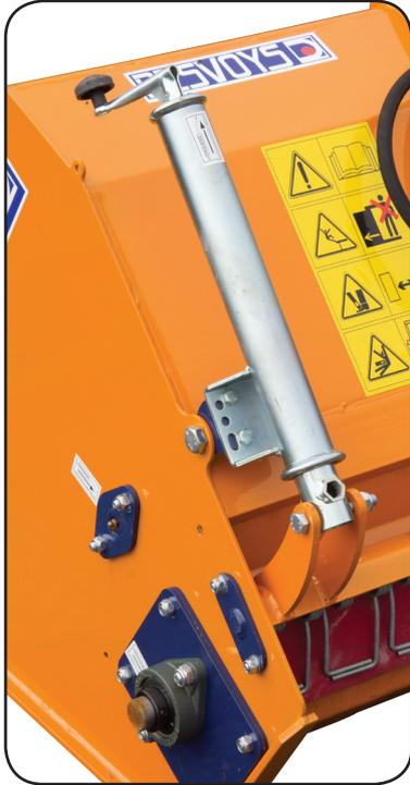
*Dispositif de réglage manivelle*
