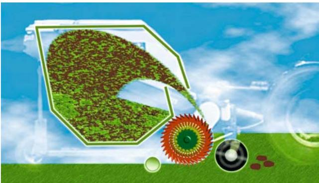
L'important effet d'aspiration produit par le rotor SmartCut, confère au Horse-Hopper une exceptionnelle capacité de ramassage. La vitesse de rotation du rotor de 2 650 tr/min. offre une qualité de coupe de premier ordre.
