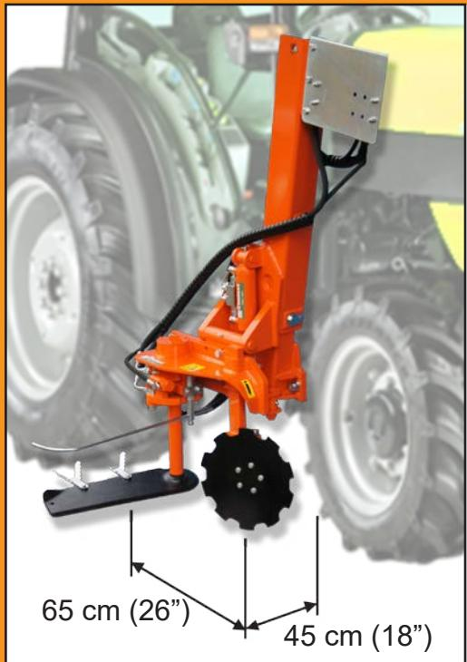
Grazie agli ingombri ridotti, è disponibile una versione TURBO ventrale da montare fra le ruote del trattore. Questa soluzione è la migliore in termini di visibilità. Il telaio dispone di alzata ed inclinazione idrauliche di serie mentre lo spostamento laterale è di serie manuale ma può essere aggiunto un martinetto idraulico. Qualora il trattore non avesse le connessioni idrauliche necessarie è possibile aggiungere una eletrovalvola con joystick per il controllo degli spostamenti
