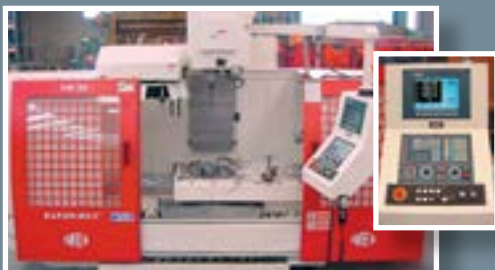
Centre d'usinage à commande numérique
