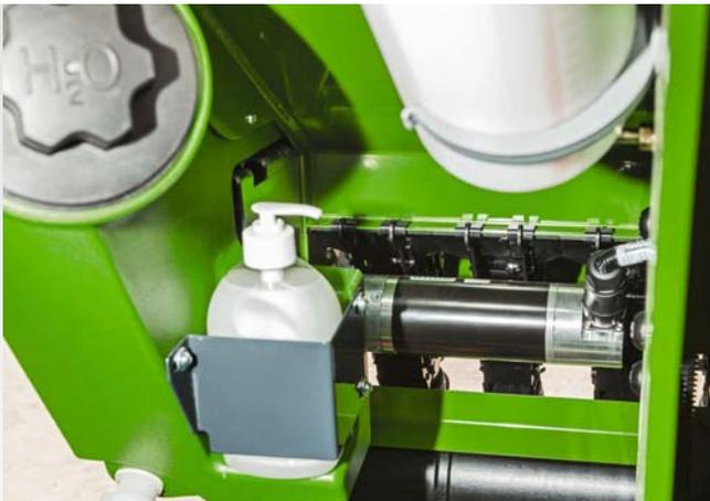
Sécurité du dosage en continu avec entraînement électrique de l'arbre de distribution
