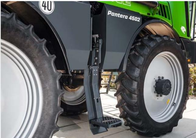
Nouvelle échelle d'accès au réservoir
