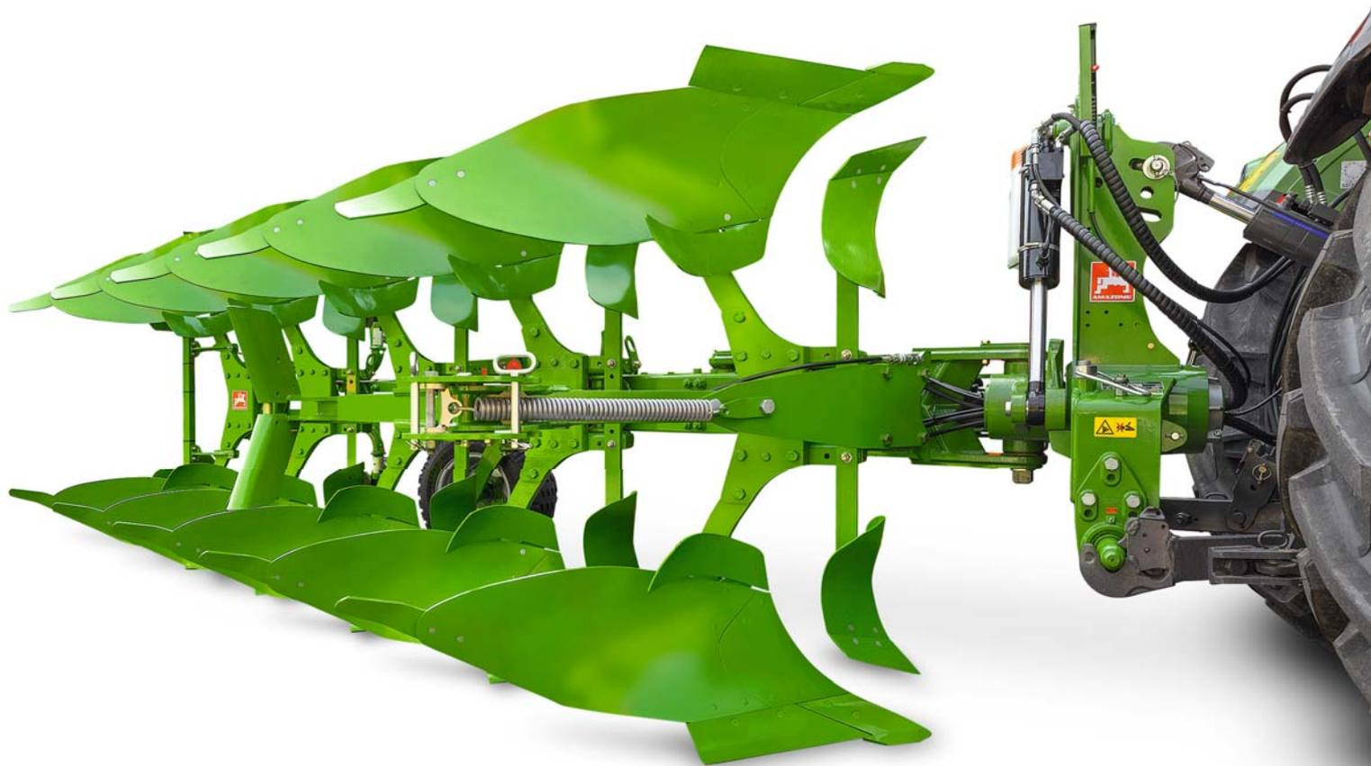
Corps hélicoïdal C-Blade W 35 avec dispositif d'incorporation de la paille en option
