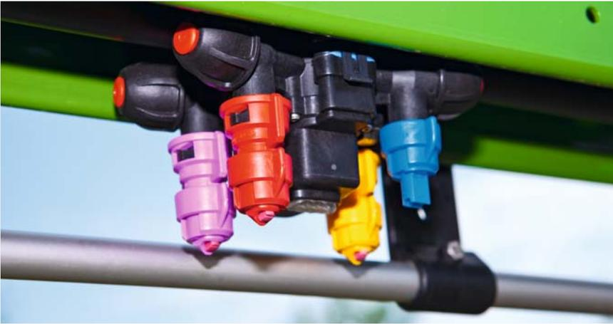
Le dispositif AmaSelect est de série sur tous les pulvérisateurs UX Platinum : changement de buse automatisé, coupure GPS buse à buse, LED incorporé au porte-jets
