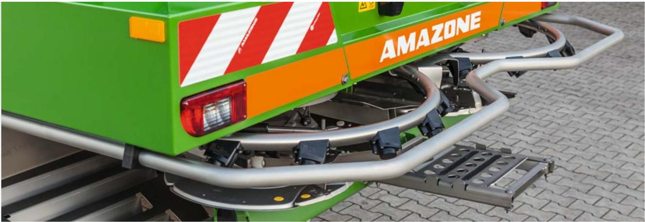
Que cela soit sur l'épandeur porté ZA-TS ou sur l'épandeur traîné ZG-TS, le système Argus Twin assure une répartition transversale optimale de l'engrais, par le biais de la surveillance en ligne permanente et de la correction du système d'alimentation. L'efficacité de l'engrais, à la base d'une gestion optimale de la culture, est ainsi renforcée.
