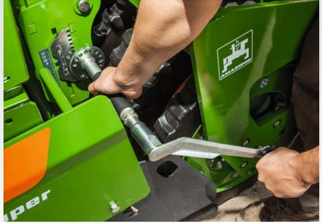
Réglage de la lame nivellement avec l'outil de réglage universel
