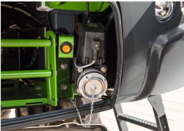
Hydroremplissage dans l'espace de rangement avec arrêt automatique de remplissage
