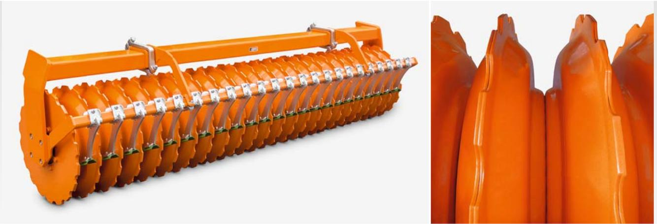
La construction de base du rouleau Disc est composée d'éléments plateaux en acier soudés et fermés par paire avec arêtes extérieures crénelées
