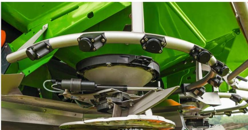
Le nouveau ZA-TS Platinum vient coiffer la gamme des épandeurs portés AMAZONE. Il est la synthèse du savoir-faire AMAZONE en matière d'épandage d'engrais. Il combine l'excellence du ZA-TS à entraînement hydraulique des disques avec le terminal haut de gamme AMAPAD et le nouveau dispositif de contrôle en continu des nappes d'engrais Argus Twin.
