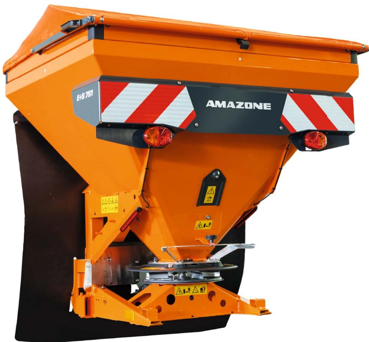
Le nouvel épandeur AMAZONE est équipé d'une trémie de 750 l, d'un entraînement hydraulique du disque d'épandage et d'une régulation de débit en fonction de la vitesse
