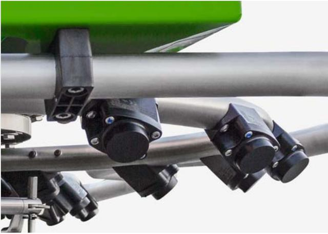
Les capteurs radar
