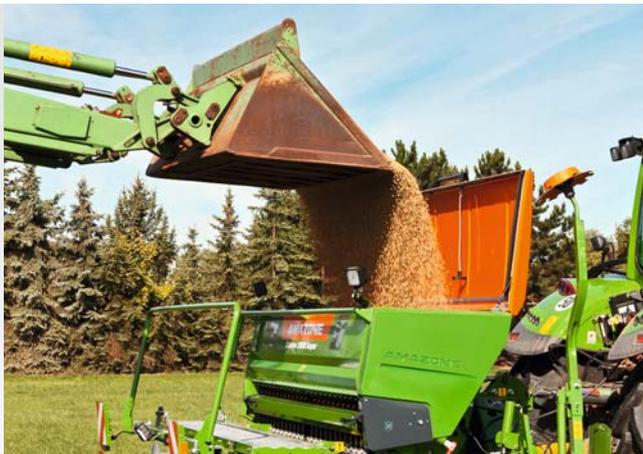
Remplissage confortable par chargeur frontal
