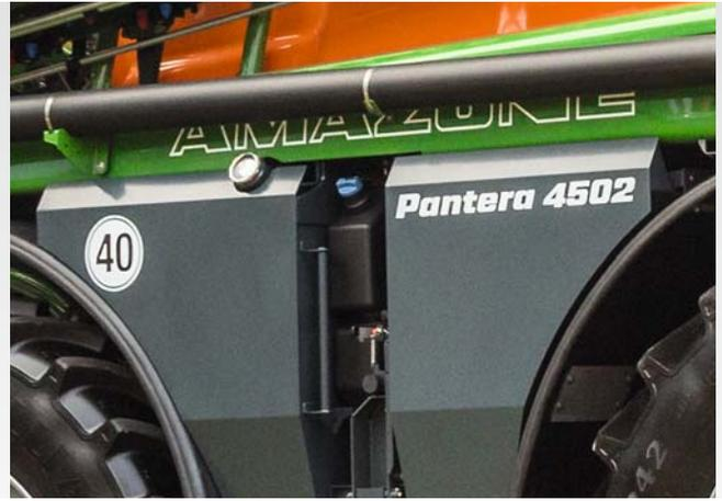
Réservoir de fluide d'échappement diesel intégré
