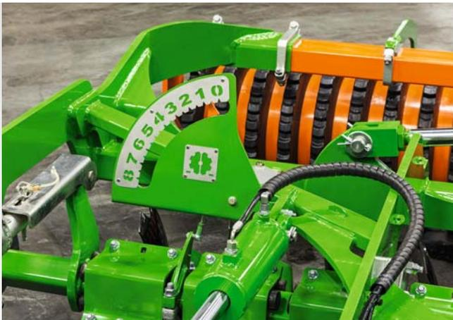
Réglage hydraulique de la profondeur de travail de série
