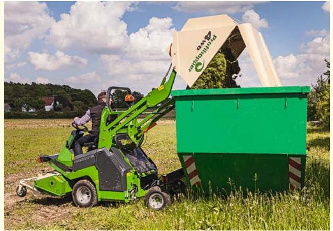
⊕ « La vidange en hauteur de la benne a également été fortement louée. Le Profihopper peut ainsi vidanger le produit de la tonte dans une benne jusqu'à une hauteur de 2,10 m. »
