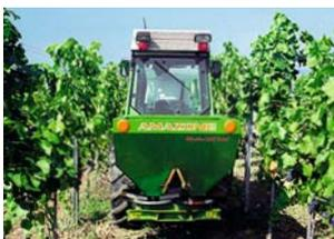
Epandeur d'engrais double disque
