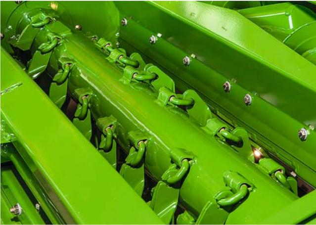
⊕ « L'unité de tonte coupe l'herbe très proprement et le produit de la tonte est convoyé par l'intermédiaire des vis d'Archimède dans la benne gros volume, ceci même en conditions humides. »
