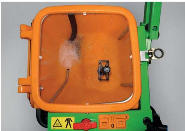
L'injecteur Power vous permet d'obtenir un rendement de remplissage important. Il s'agit du même bac incorporateur que sur le pulvérisateur traîné UX.
