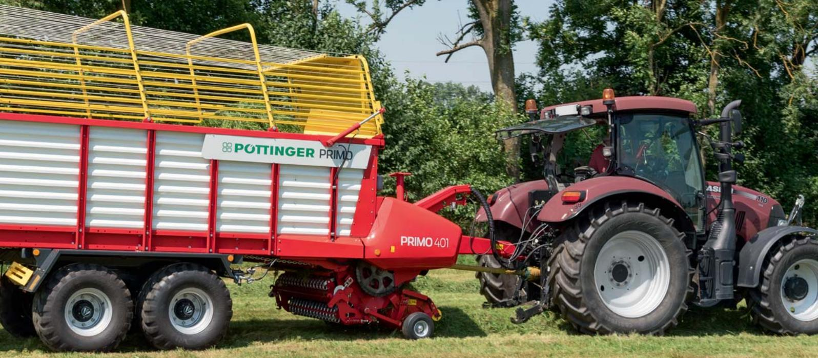
**Le train d'entraînement est conçu pour des efforts importants. Les remorques PRIMO sont conçues pour des puissances allant jusqu'à 130 ch.**
