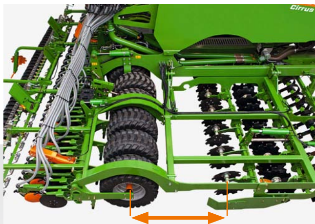
Espace libre pour favoriser le nivellement et améliorer le roulement
