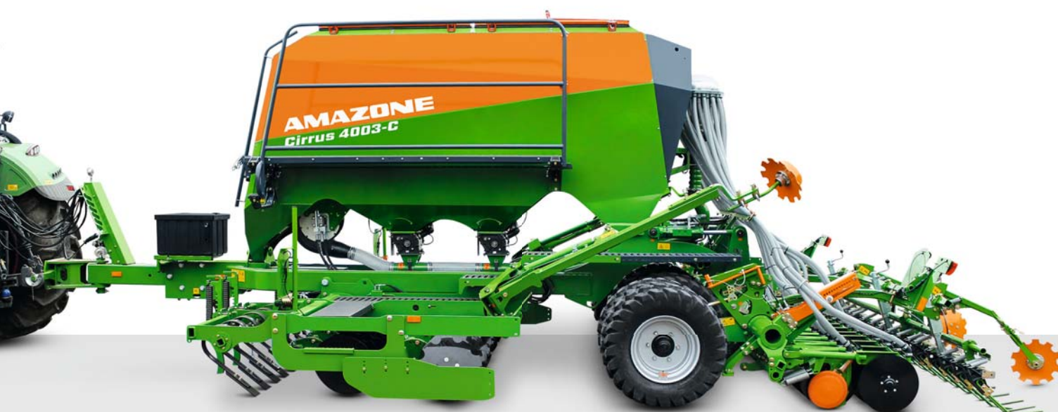
Cirrus 4003-C doté d'une trémie sous pression à 2 compartiments pour la semence et l'engrais
