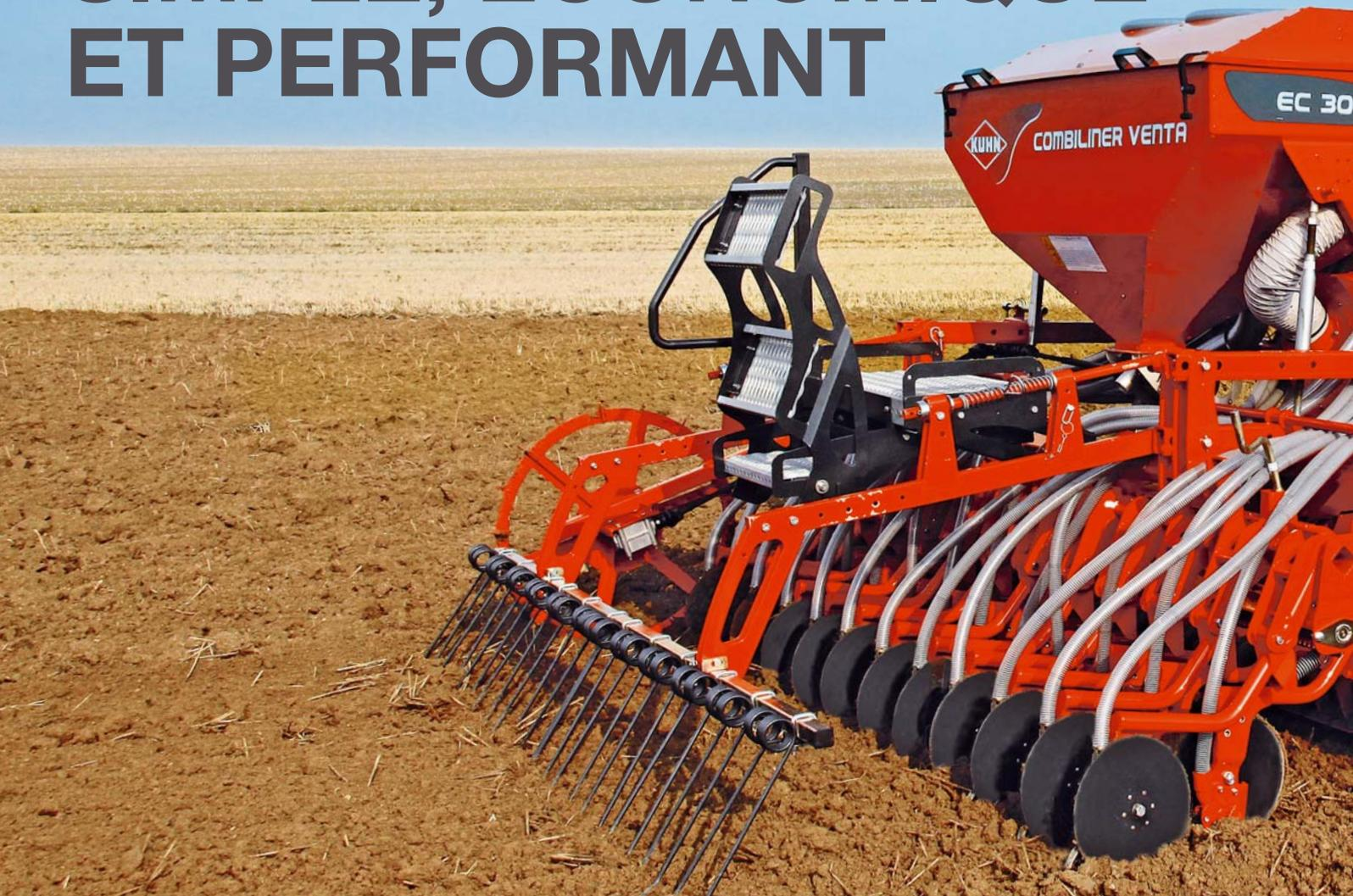
Le **COMBILINER VENTA EC 300** est destiné aux exploitations céréalières et de polyculture-élevage de taille moyenne. Avec une largeur de travail de 3,00 m et une trémie de 800 litres, il est adapté aux tracteurs de puissance moyenne de 66 à 112 kW (90 à 150 ch).
