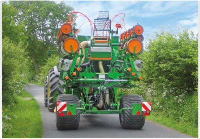
Grâce au mécanisme de repliage ingénieux, tous les semoirs monograins EDX peuvent être repliés en un rien de temps pour les déplacements sur route avec une largeur au transport de 3 m.
