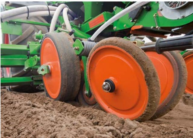
Fermeture du sillon par roulettes de rappui Super-V
