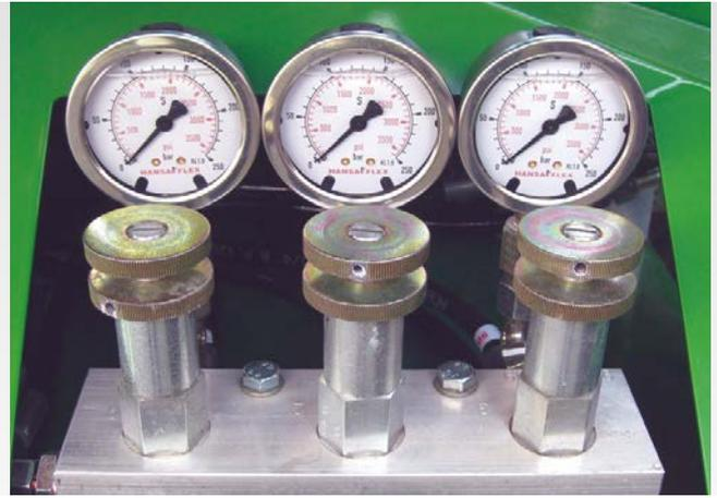
Réglage manuel de la pression d'enterrage sur EDX 9000-TC
