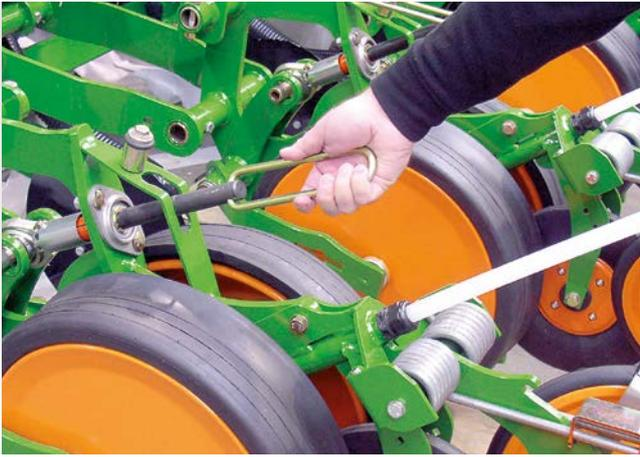
Réglage de profondeur par manivelle
