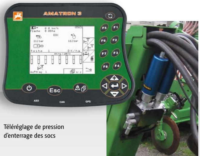
Télé réglage de pression d'enterrage des socs
