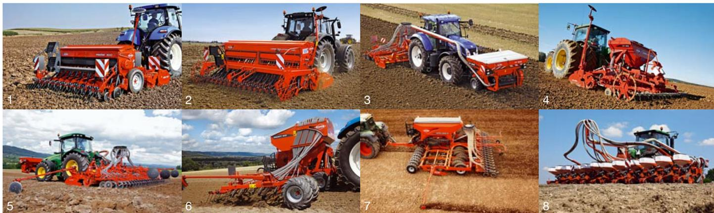
1. portés mécaniques / 2. intégrés mécaniques / 3. avec trémie frontale / 4. intégrés pneumatiques / 5. traînés pneumatiques / 6. portés pour semis simplifié / 7. traînés pour semis simplifié / 8. monograine
