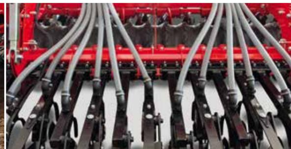
Position optimale des éléments semeurs derrière le rouleau en bandes. Chaque élément semeur évolue exactement là où une bande de ré-appui est plus prononcée.
