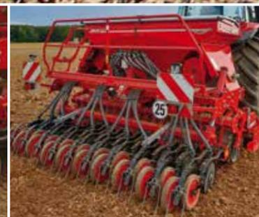
Trémie semences avec une capacité de 1 500 litres.
