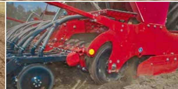
Rouleau FarmFlex pour un ré-appui ciblé en bandes et une utilisation polyvalente dans tout type de sol.
