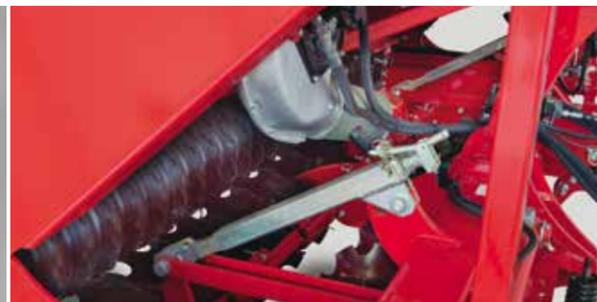
Réglage de la profondeur du DiscSystem par deux manivelles. En option, deux vérins hydrauliques permettent de varier la profondeur en cours de travail.
