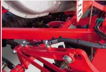
Réglage hydraulique de profondeur du DiscSystem (option)
