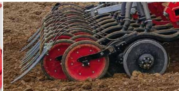
La capacité de suivi du sol du TurboDisc avec sa roulette de plombage intégrée est au dessus de la moyenne (15 cm) et permet un maintien parfait de la profondeur de semis. La pression élevée sur chaque élément semeur facilite une évolution sans heurt même avec une vitesse de semis importante.
