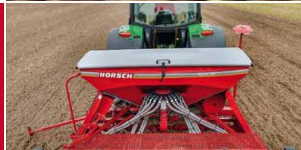
Trémie semences avec une capacité de 1 500 litres.
