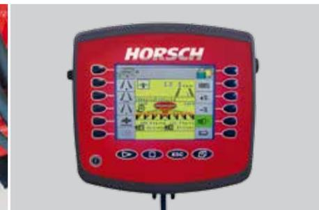
Terminal HORSCH pour la surveillance et le pilotage des fonctions du semoir
