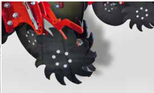
Etoiles Chasse résidus devant les disques de fertilisation, en option
