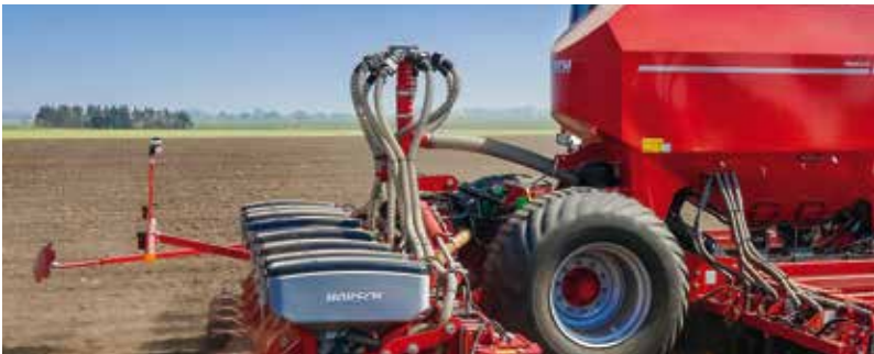
Tête de distribution et attelage trois points (Maestro RC)
