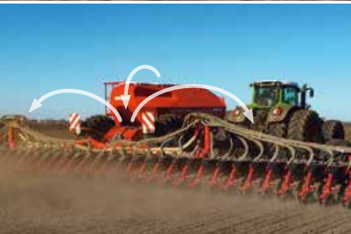
Transfert du poids de la remorque semoir sur la rampe de semis pour une pression plus importante sur les éléments semeurs
