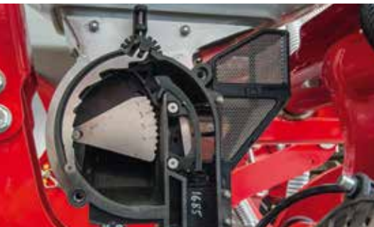
L'unificateur réglable transporte la graine dans le tube de descente sans influence des forces centrifuges
