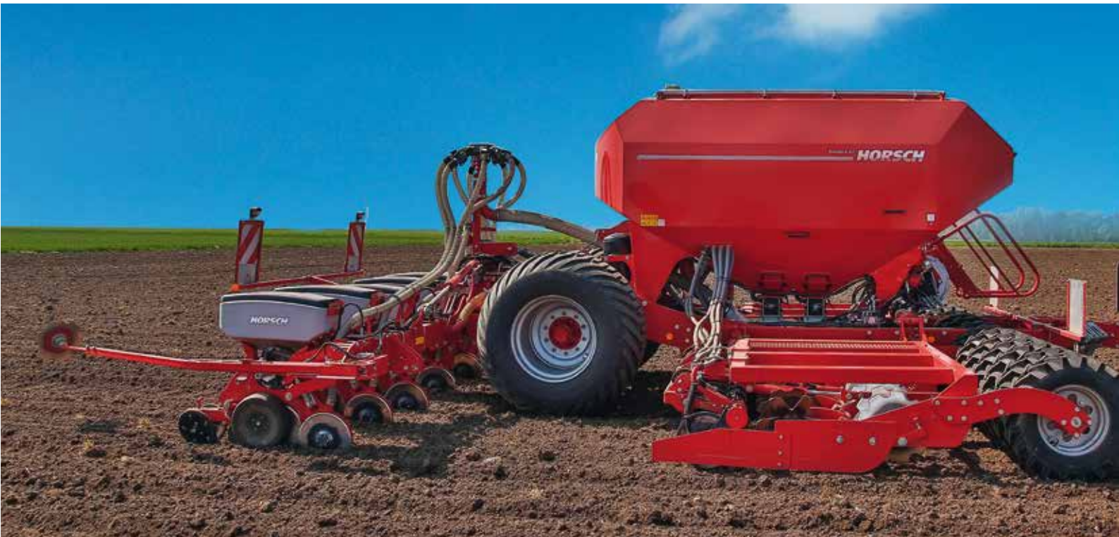
Maestro RC : rampe de semis Maestro (8 ou 12 rangs) en combinaison avec la remorque semoir SW 3500 du Pronto AS. Le changement de rampe de semis de Pronto et de Maestro s'opère via un troisière point.
