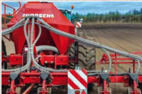
Productivité maximale avec la remorque semoir de 2 000 litres pour la semence et 7 000 l pour l’engrais
