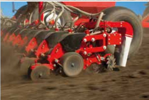
Elément semeur monograine robuste, incluant un système de sélection précis et le dispositif Seed on Demand
