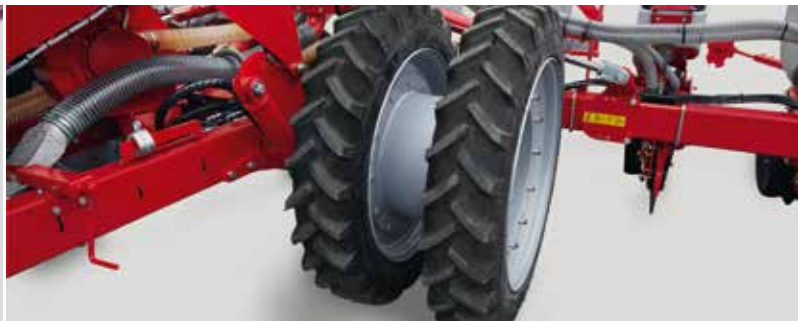
Option : roues jumelées 230/95 R 32 pour Maestro CC , permettant le semis exactement entre deux pneus
