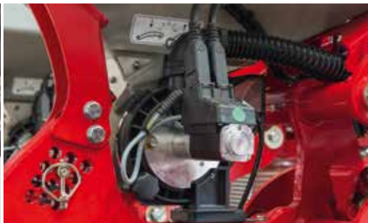
Distribution brevetée unique, incluant système de sélection, micro-ordinateur et moteur, dans un seul carter
