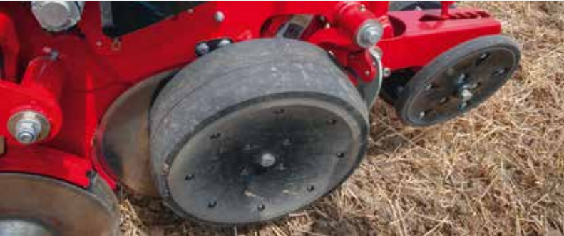
Capteur de pression AutoForce : l’enregistrement de la pression se fait avec un capteur Piezo (Capteur de pression)
