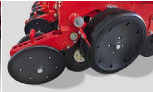
Roues de terrage avec décrottoir, roues de plombage réglables et roulette de plombage escamotable, par exemple, en conditions humides pour éviter qu'elle ne déterre les graines
