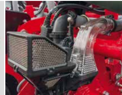
Maestro SW : Système de répartition du Seed on Demand
