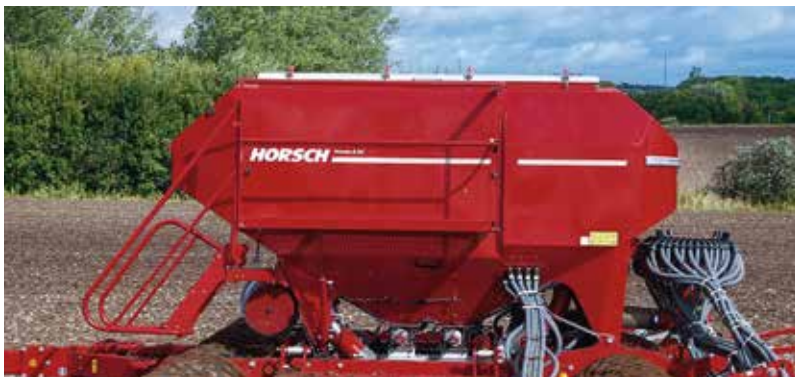
Trémie double cuve de grande capacité Jusqu'à 5 000 l de capacité, répartition 40/60
