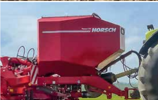
Productivité lors du semis La trémie du Pronto KR a une capacité de 2 800 litres.
