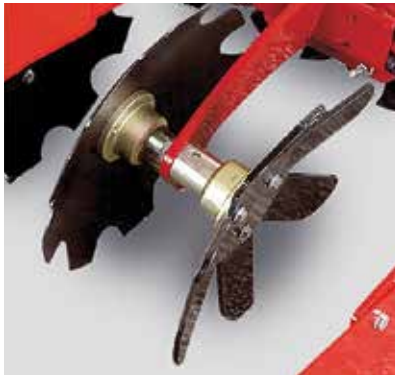
Montage des disques par paire Plus de dégagement pour une sécurité d’utilisation renforcée
