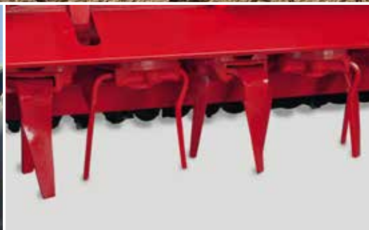
Herse rotative Elle pénètre dans le sol et maintient en permanence la profondeur de travail réglée.
