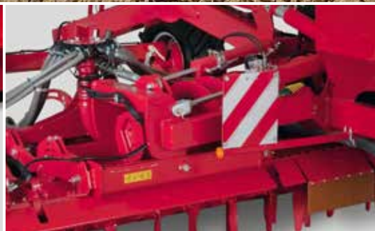
Les segments de 3 m sont pendulaires et permettent un suivi optimal de la surface du sol.
