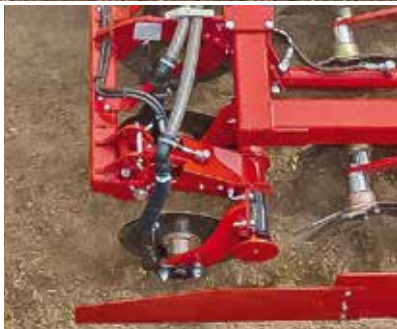
Elément d'apport d'engrais PPF Placement précis de la fertilisation entre deux lignes de semis
