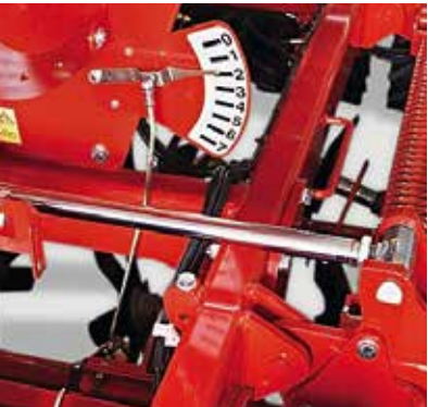
Réglage de profondeur des outils frontaux Visible depuis la cabine et réglable hydrauliquement en cours de travail
