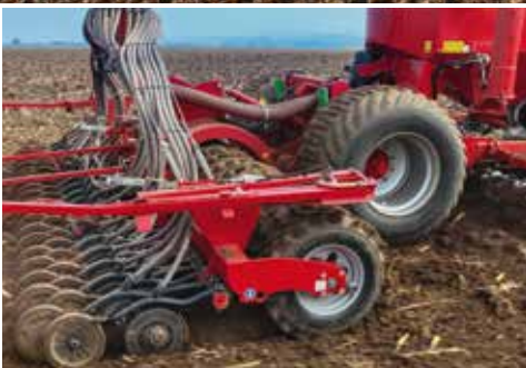
Châssis de transport Pronto AS Pneus de grand diamètre (800/40 – 26,5), peu tirants et respectueux du sol Relevage arrière trois points Changement simple et rapide des outils
