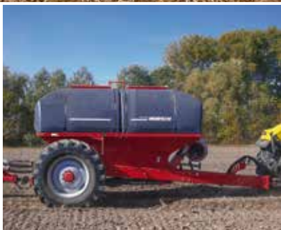
Remorque semoir HORSCH Avec 12 000 litres de capacité pour l'engrais et la semence (répartition 50/50)
