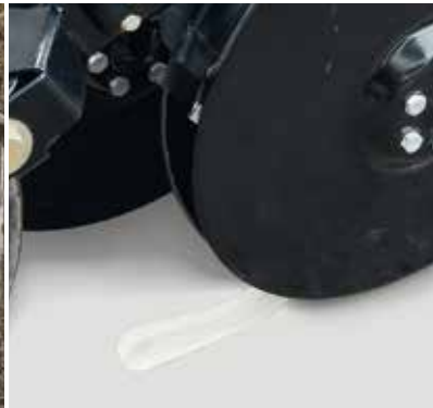
Languette téflon et décrotteur Positionnement sécurisé de la graine, même en conditions humides
