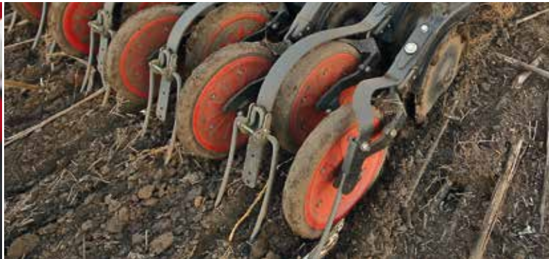
Elément semeur à double disque Disques droits avec roulements intégrés, sans entretien
