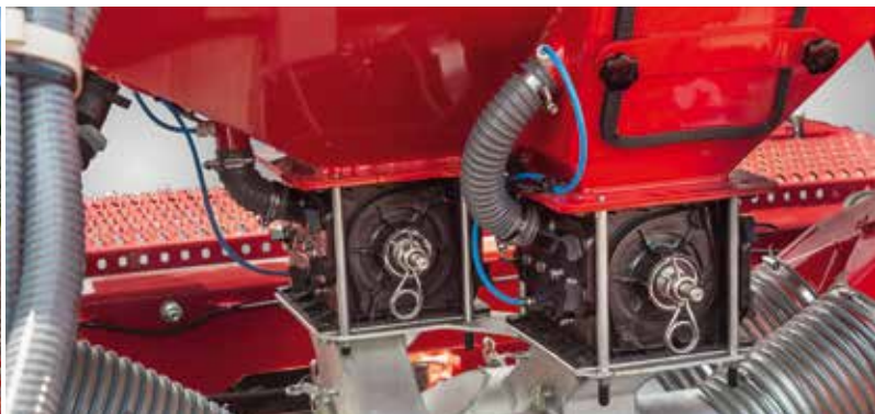
Double distribution Dosage précis et adapté de la semence et de l'engrais
