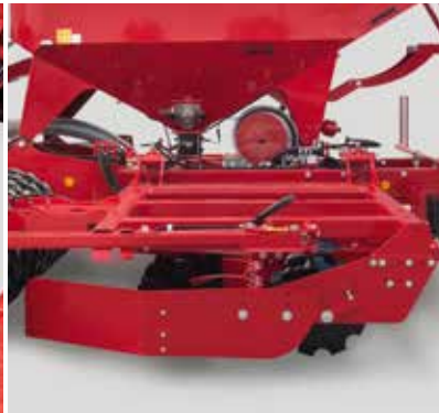
Tôles latérales Evitent la formation de billons latéraux
