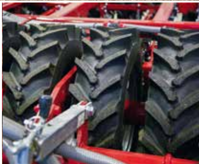
Packer à pneus avec profil agraire optimisé Ré-appui ciblé devant chaque élément semeur
