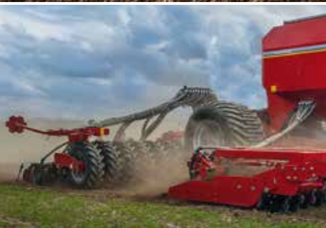
Châssis de transport Pronto AS Pneus de grand diamètre (800/40 – 26,5), peu tirants et respectueux du sol Relevage arrière trois points Changement simple et rapide des outils
