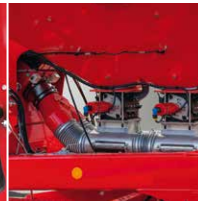
Dispositif « Grain & Fertilizer » sur Pronto pour un apport simultané de semences et d'engrais
