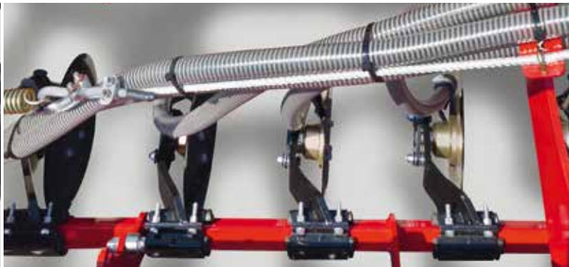
Réglage de profondeur variable Dépôt de l'engrais au centre du pneu et entre deux lignes de semis
