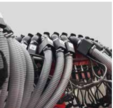
Capteurs de contrôle de circulation des grains et de l'engrais
