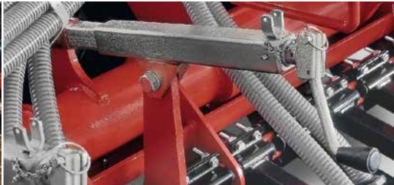
Réglage de la profondeur des éléments semeurs en continu Un réglage manuel augmente la torsion des suspensions caoutchouc
