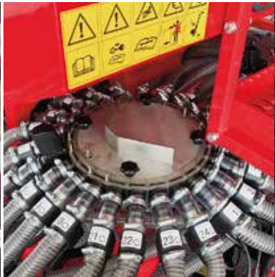
Coupure mécanique demi-semoir
