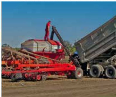
Productivité élevée Grâce à sa grande trémie et ses ouvertures de remplissage de grande capacité
