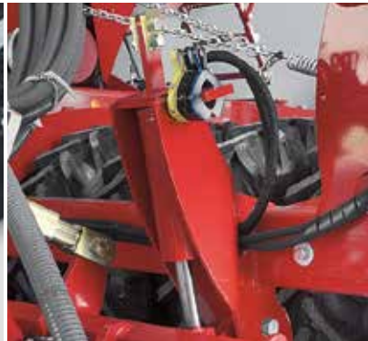
Réglage précis de la profondeur de travail Changement simple et rapide de la profondeur au moyen de cales sur le vérin
