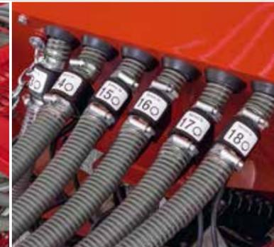
Contrôle permanent de la densité de semis par capteurs très sensibles (option)
