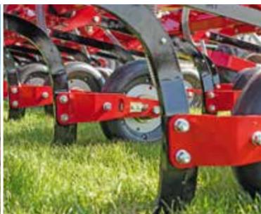
Les socs étroits dégagent les mottes de l'horizon de semis et déposent précisément la semence
