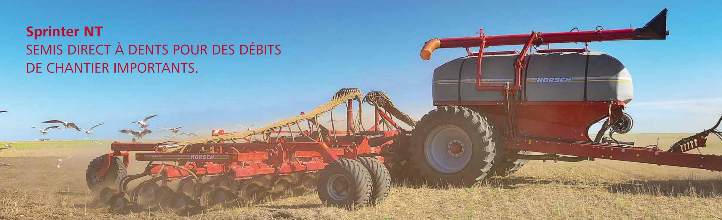
Le Sprinter NT, disponible en largeur de 11 et 24 m, permet une productivité maximale. La pointe du semoir HORSCH NT fabrique beaucoup de terre fine au niveau de la ligne de semis et dépose la semence dans un «sillon ouvert».
