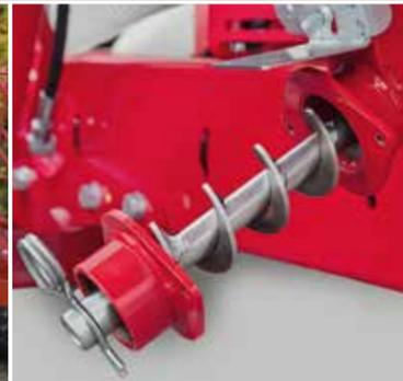
Doseur avec vis sans fin du microgranulateur (Sprinter 3/4/6 ST)
