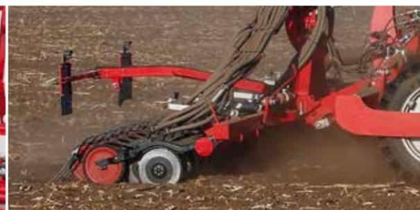
Le suivi du sol des **éléments semeurs TurboDisc à roue plumbeuse intégrée** permet un contrôle de profondeur précis et régulier. La pression élevée exercée sur les disques allant jusqu'à 120 kg garantit une conduite régulière à grande vitesse.
