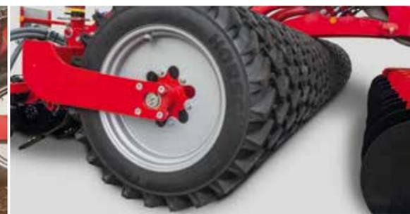
**Packer à pneus** pour le contrôle de profondeur des dents et pour le rappui du sol avant le passage des disques semeurs
