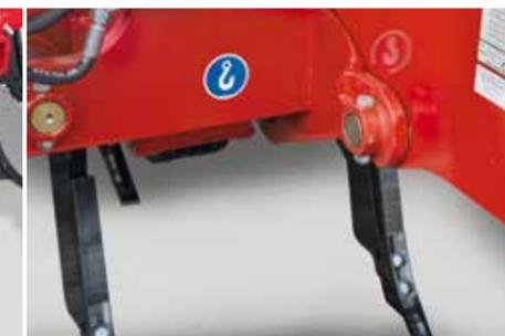
**Points d'ancrage** pour le remplacement des dents par un système à disques. Changement simple grâce à 4 points de fixation seulement.
