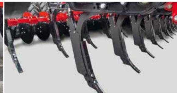
**Dents TerraGrip avec soc LD (low disturbance)** fissurent en profondeur sous la ligne de semis et écartent les résidus de culture de la rhizosphère
