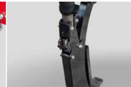
La dépose de l'engrais s'effectue de manière superficielle, profonde ou combinant les 2
