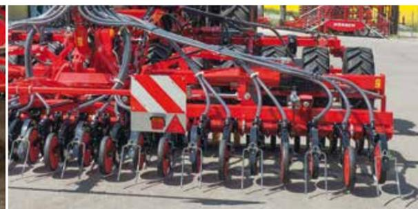
Un **élément semeur TurboDisc** suit toujours le centre d'une **dent TerraGrip** et d'un pneu
