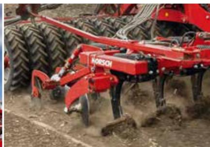
Chaque **dent TerraGrip** travaille exactement dans l'axe d'une roue du packer
