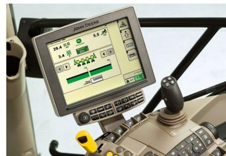
Le « CommandCenter » 4600 prend en charge la commande de jusqu'à 96 sections d'équipement individuelles. Il vous offre une précision maximale et différentes possibilités de réduction des coûts.
