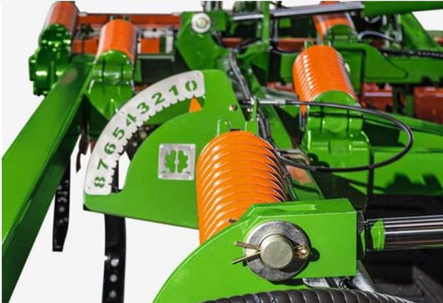
Echelle graduée pour la position de travail des outils de nivellement
