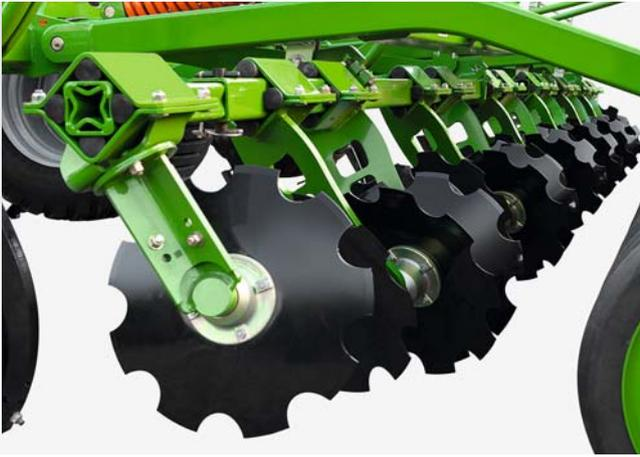
Disques de nivellement crénelés
