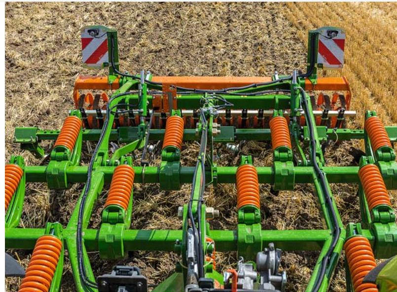
Structure du châssis sur 3 rangées du Cenius 3003 Super
