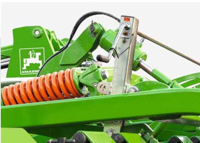
L'inclinaison et la hauteur de l'élément de bordure sont réglables séparément pour réaliser un raccord optimal
