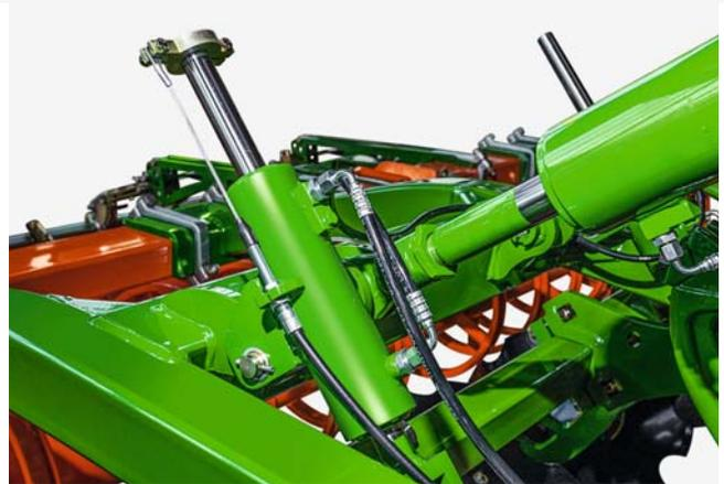
Réglage hydraulique central des outils de nivellement
