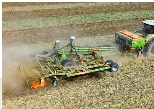
XTender 4200 avec Cenius 6003-2TX et deux voies d'alimentation pour appliquer l'engrais et la semence
