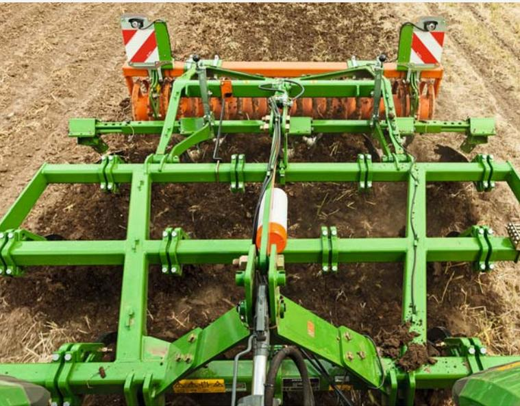
Structure du châssis sur 3 rangées du Cenius 3003 Special
