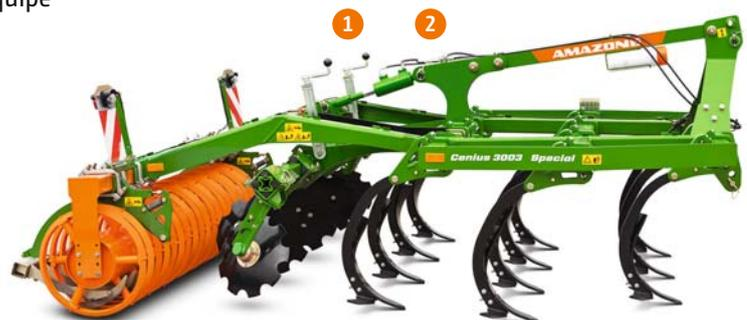
Cenius Special : dents C-Mix avec sécurité de surcharge par boulon de cisaillement et rouleau couteaux
