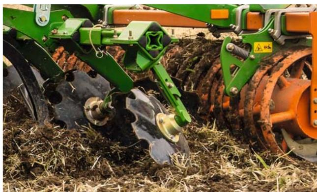
Disques de nivellement crantés de 460 mm pour une utilisation également avec des volumes de paille élevés. Effet d'incorporation supérieur par rapport aux disques lisses, l'entraînement est assuré en permanence.
