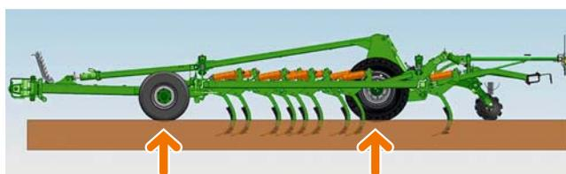
spéciaux. Lors du dételage du rouleau, celui-ci est posé sur le support. Après avoir desserré l'étrier de blocage, le Cenius TX peut être facilement déplacé.
