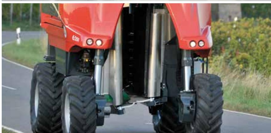
La suspension de l'essieu avant augmente le confort et la sécurité de la conduite en terrain non stabilisé.
