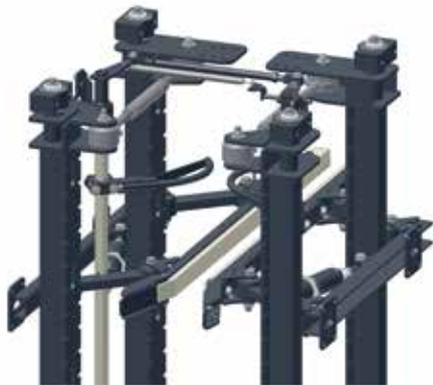
Guide-piquets et détection des piquets avec arrêt automatique du secouage permettent l'utilisation dans les parcelles avec piquets en béton.
