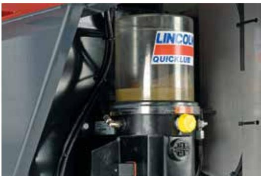
Le graissage centralisé pour une alimentation constante des composantes en graisse.
