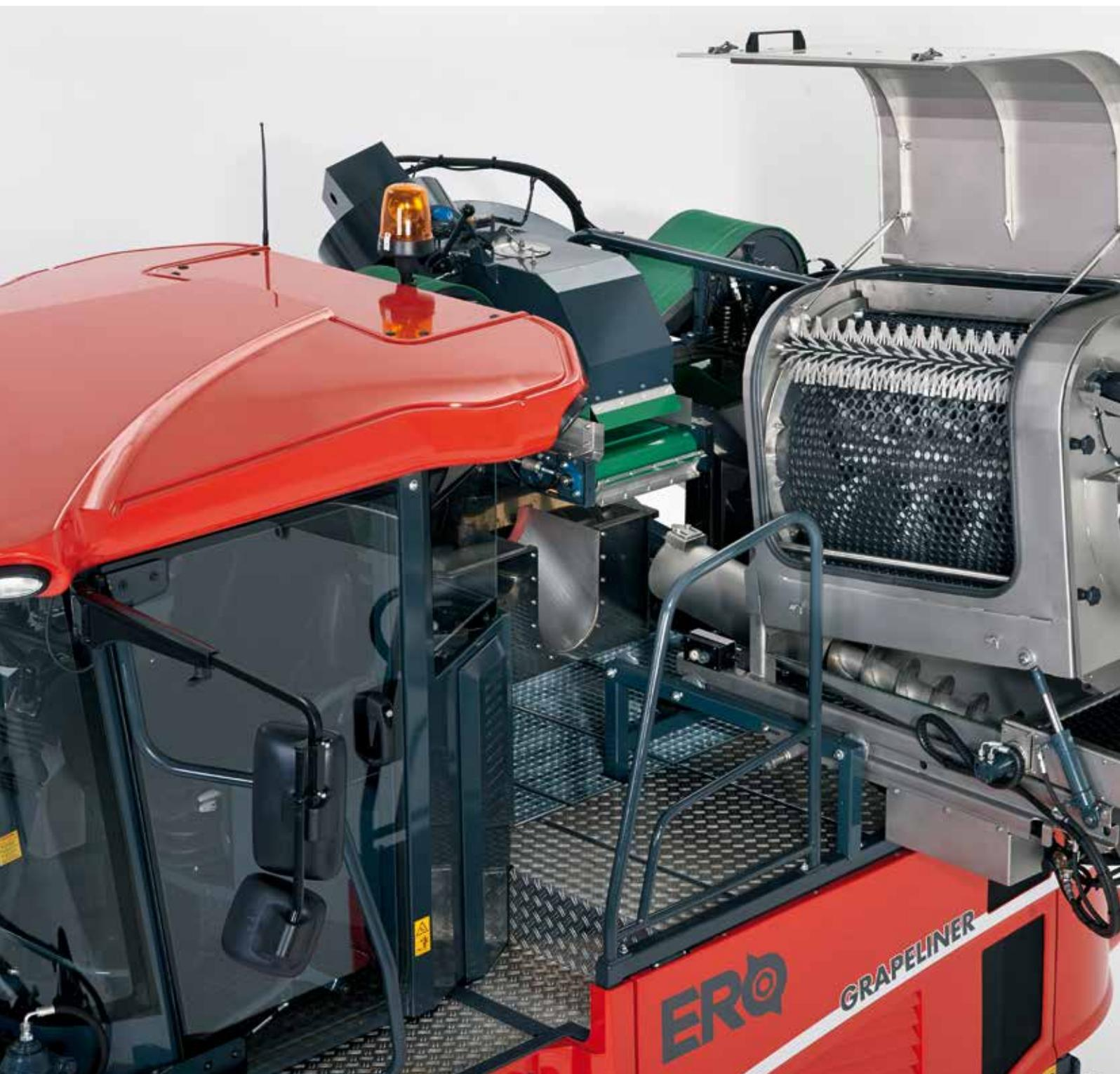
Seules les précieuses baies doivent arriver dans la trémie, c'est pourquoi ERO propose la Grapelin 6000 équipée de la table de tri **VITselect**. L'égrappoir avec table de tri vient compléter notre système éprouvé de triple nettoyage pour une vendange parfaite. La table de tri peut traiter une grande quantité de raisin et livre une vendange de toute première qualité tout en travaillant à vitesse élevée.
