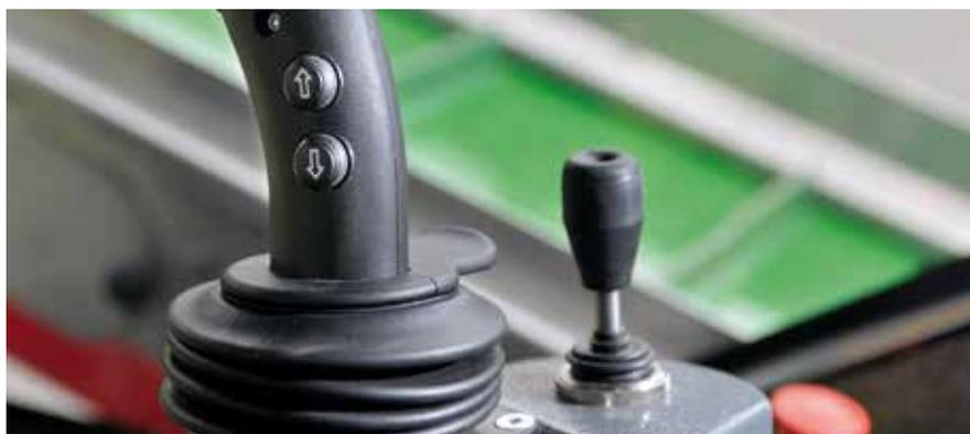
Le conducteur peut régler la hauteur et l'inclinaison du convoyeur latéral par l'intermédiaire d'un second joystick.
