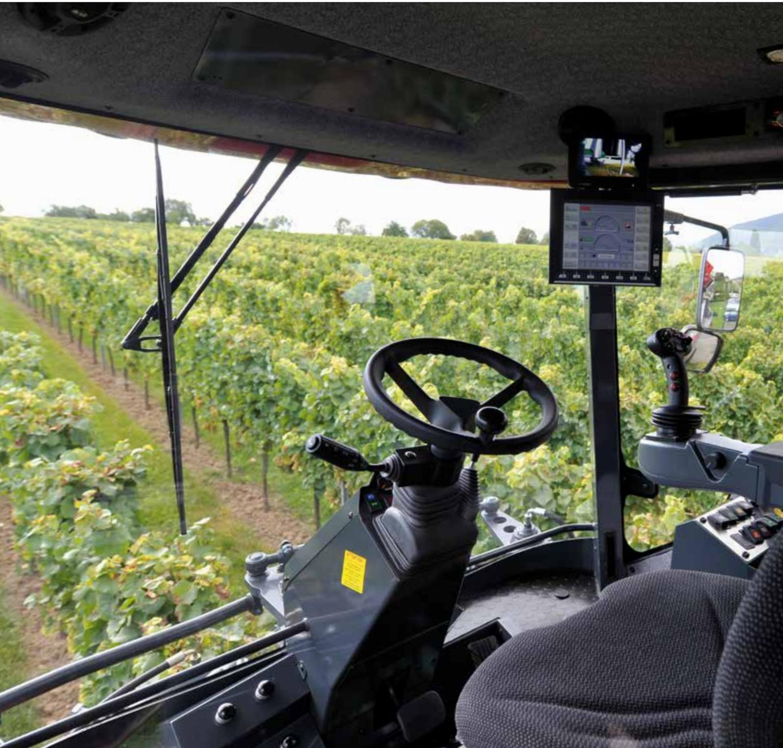
La cabine centrée dispose d'une grande surface vitrée pour une visibilité sur 360°, et, avec son volume de plus de 3 m<sup>3</sup>, c'est la plus grande sur ce type de machine à l'heure actuelle sur le marché. Le plancher vitré assure une vue dégagée sur le rang de vigne. L'insonorisation et l'amortissement des vibrations offrent un poste de travail calme, idéal pour se concentrer sur l'essentiel.
