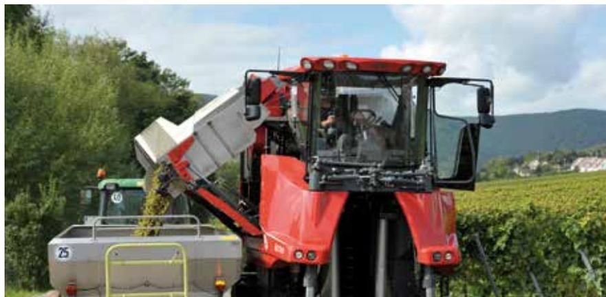
Le vidage latéral avec une seule trémie permet une surveillance optimale et représente un gain de temps appréciable.
