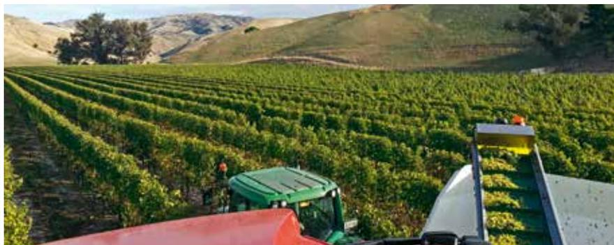
Le convoyeur transversal achemine les raisins en continu vers le véhicule de transport. Grâce à ce système, il est possible de vendanger également les rangs longs à fort rendement avec une machine.
