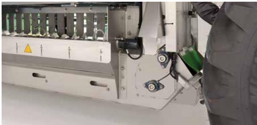
Affichage de la hauteur par capteur à ultrasons et mécanique.
