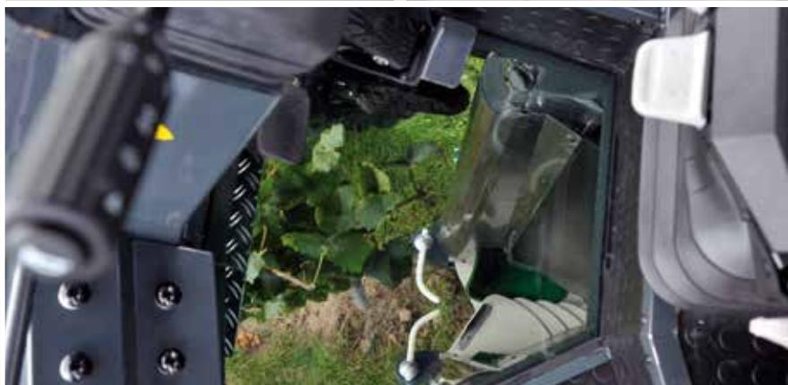
Le plancher vitré de la cabine pour une vue dégagée sur le rang de vigne.
