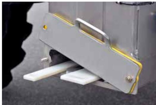
Les rails en plastique démontables permettent de nettoyer soigneusement le canal de récolte en inox.
