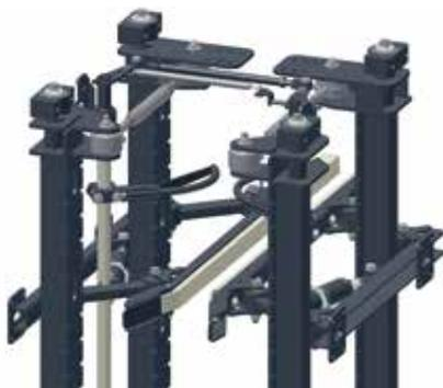
Guide-piquets et détection des piquets avec arrêt automatique du secouage autorisent les interventions dans les parcelles avec piquets en béton.
