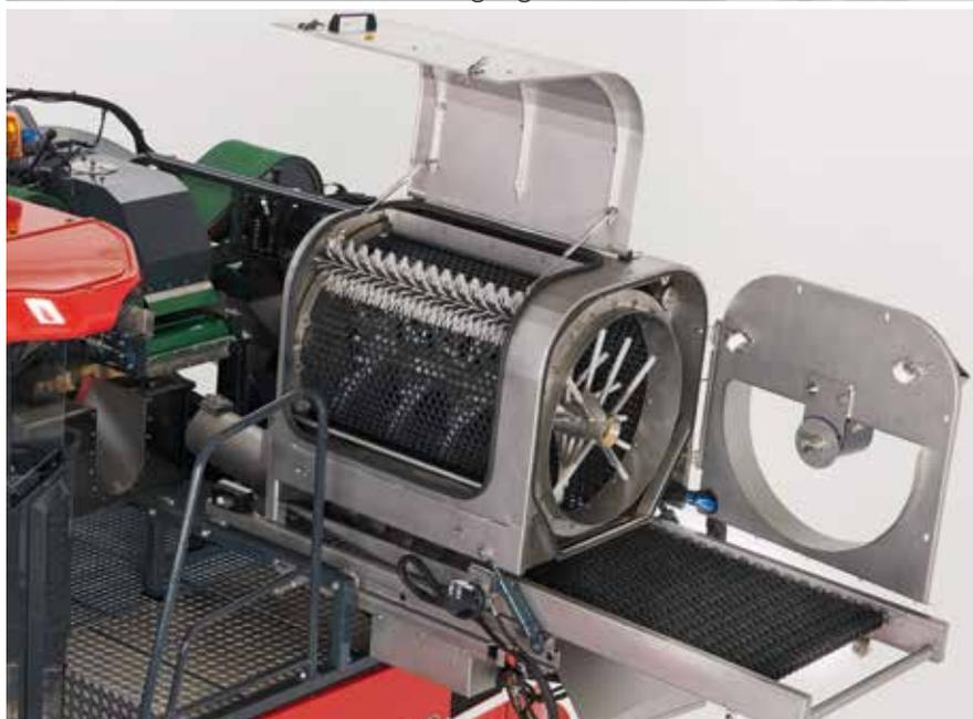
Pour nettoyer la machine et effectuer les travaux de maintenance, il suffit d'ouvrir le capot de l'égrappoir et de sortir la table de tri.
