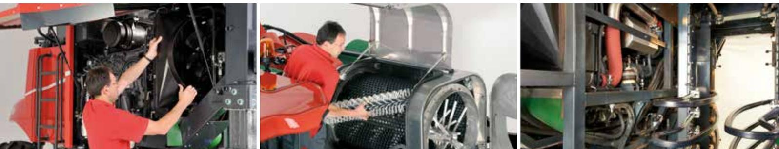
Il est très facile d'ouvrir toutes les protections pour le nettoyage et la maintenance de la Grapelinier. L'accès aux modules est ensuite immédiat. Le filtre du radiateur se démonte facilement. Le carter du ventilateur est aisément accessible grâce aux deux fermetures rapides.
