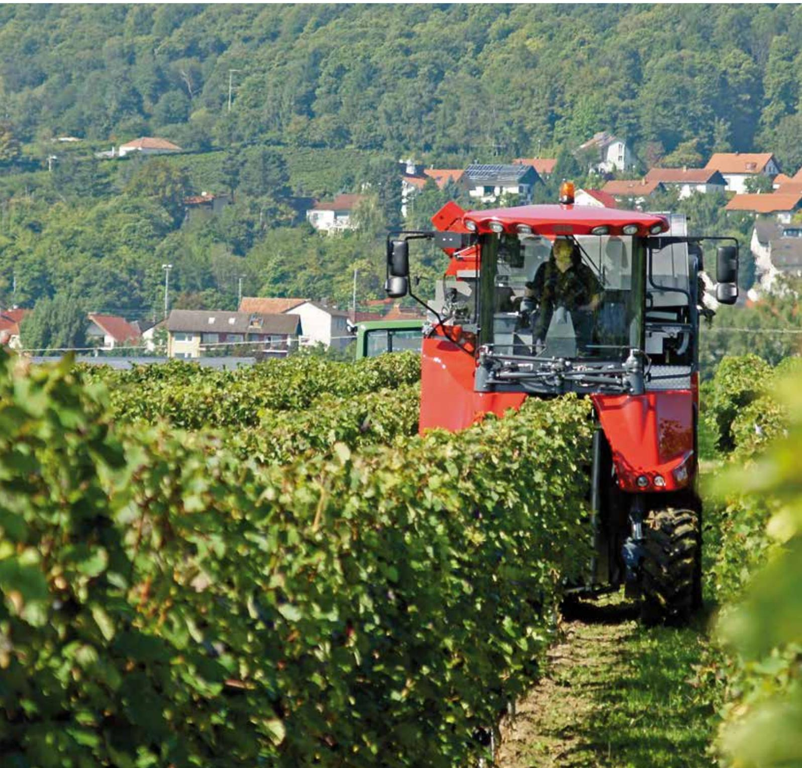
La direction automatique est un élément essentiel du confort de conduite: une fois activée, elle dirige la machine dans le vignoble en toute sécurité et guide la tête de récolte pour un enjambement optimal du rang. Ce dispositif prévient les erreurs de conduite qui risqueraient de blesser les vignes. Il permet au conducteur de concentrer toute son attention sur les paramètres de récolte pour une qualité de vendange optimale.
