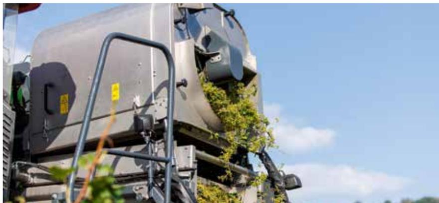
Le conducteur surveille le rejet des déchets végétaux et la vendange qui arrive dans la trémie et il peut ajuster les paramètres si nécessaire.
