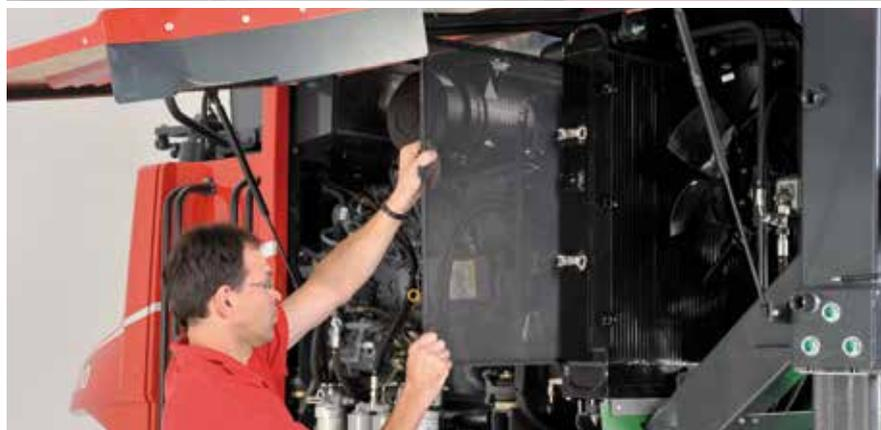
Nettoyage facile du radiateur; le carter du ventilateur est muni de fermetures rapides pour une dépose aisée.
