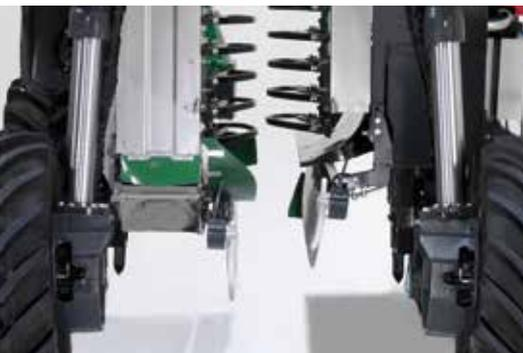
Quelques gestes simples permettent d'abaisser la rampe d'écaillés pour reculer la machine dans le rang.
