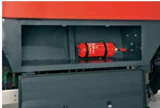
Le grand compartiment de rangement situé sous la trémie contient un extincteur en série et peut également abriter une mallette à outils ainsi que des pièces de rechange.
