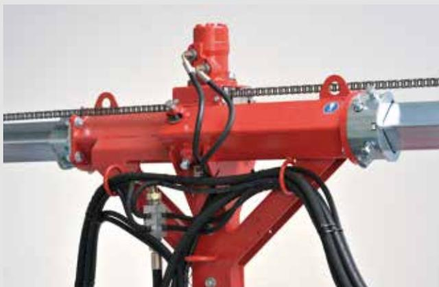
Écartement hydraulique des modules de coupe: les pièces de tête disponibles en plusieurs dimensions permettent de traiter des rangs larges de 1,38 m à 3,50 m.
