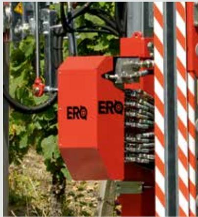
Commande électro-hydraulique Confort avec joystick (version de base, uniquement pour modèles ELITE)
