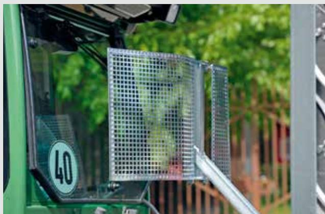
Protection anti-coupure pour rogneuse avec boogie
