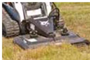
**DÉBROUSSAILLEUSE À LAMES
