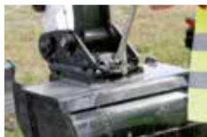
**ATTACHE RAPIDE MÉCANIQUE**
