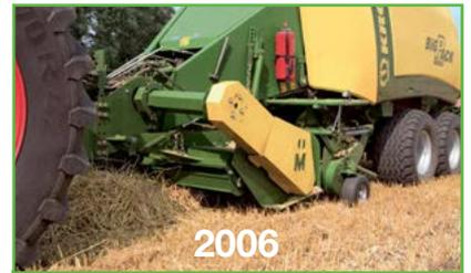
PreChop – Le broyeur sous flèche intégré améliore la récolte de la paille et élargit les possibilités d'utilisation des balles cubiques.
