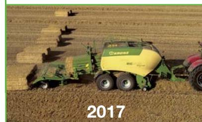
2017 : avec le groupeur de balles BaleCollect, KRONE optimise efficacement le conditionnement de la paille. BaleCollect regroupe jusqu'à trois balles dans le champ. Sur route, BaleCollect suit la presse sur sa voie et en toute sécurité, grâce au timon télescopique.
