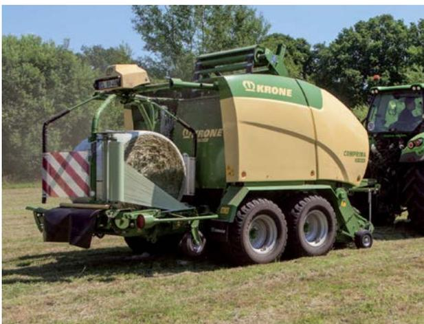
**Comprima CF 155 XC le combiné presse + enrubanneuse avec chambre fixe à diamètre variable**
