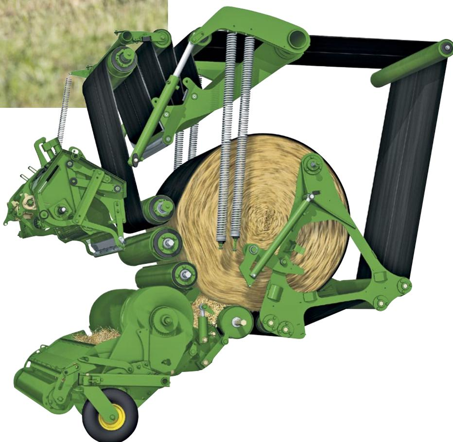
Deux larges courroies sans fin de 576 mm permettent la formation de balles denses et une couverture de balles parfaite pour toutes les récoltes. Un système de guidage de courroie très précis assure un guidage parfait dans toutes les conditions. Trois rouleaux en chambre assurent une forme parfaite quelle que soit le taux d'humidité de la récolte.
