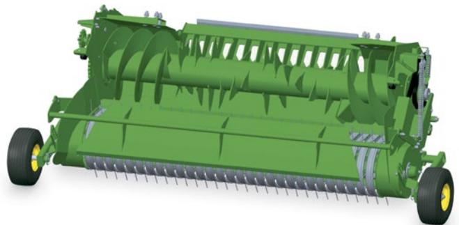
Rotor Haute Capacité avec des dents en acier Hardox® pour une longévité accrue.
